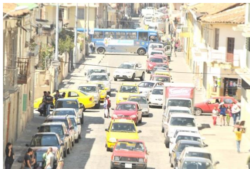
Figura 1.13 Nivel de Servicio F Fuente: Autores
