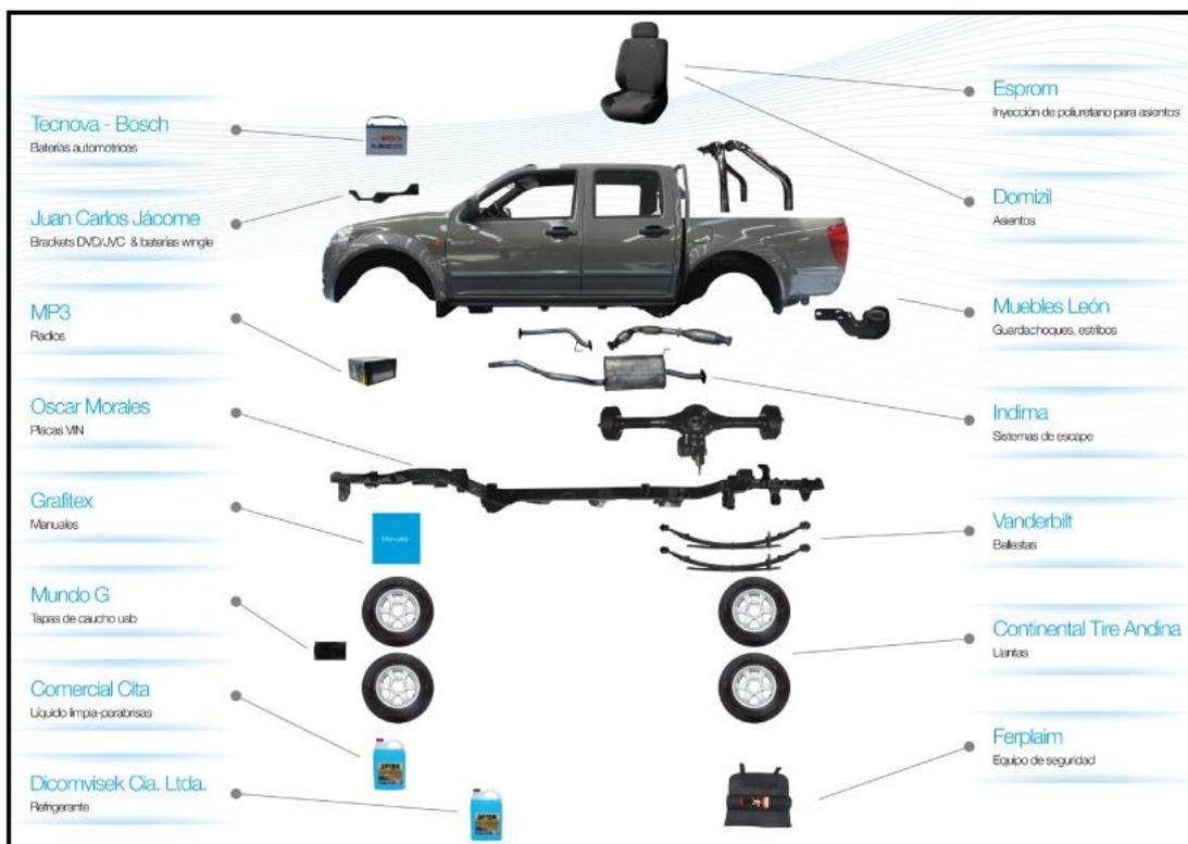
**Figura 2.24.** Integración de autopartes locales en la camioneta Great Wall.
