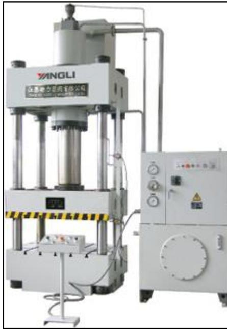
**Figura 3.134.** Prensa hidráulica para estampado.
