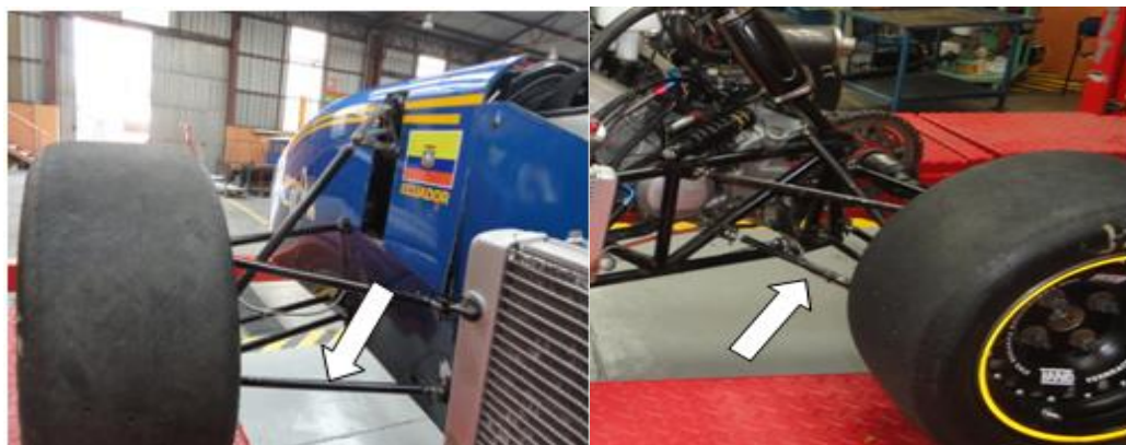
Figura 2. 10. Brazos instrumentados de la suspensión del vehículo Fórmula SAE
