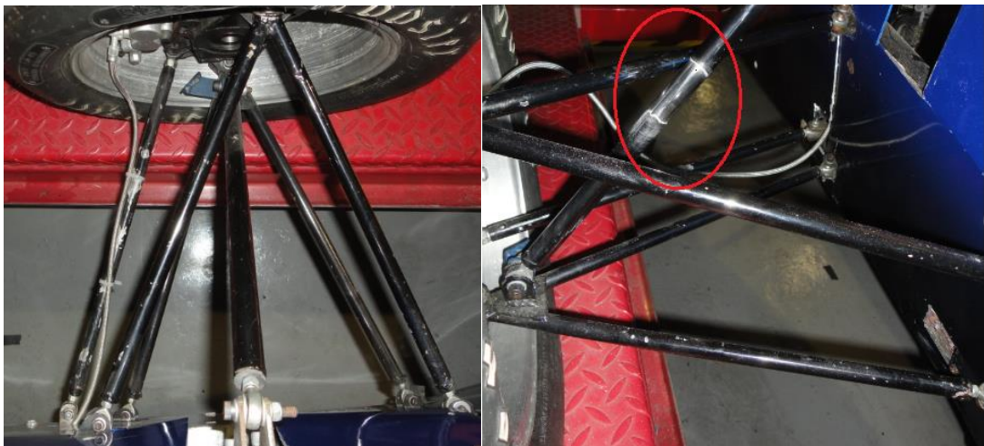
Figura 2. 21. Limpieza burda (extracción de la pintura) de las barras de suspensión
