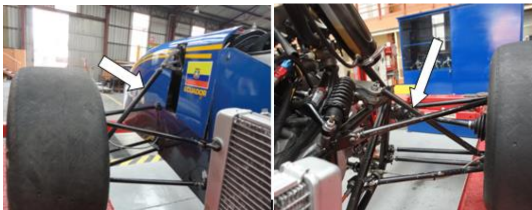
Figura 2. 11. Push rods instrumentados de la suspensión del vehículo Formula SAE
