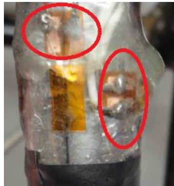
Figura 2. 33. Soldado de los terminales con ayuda de las almohadillas
