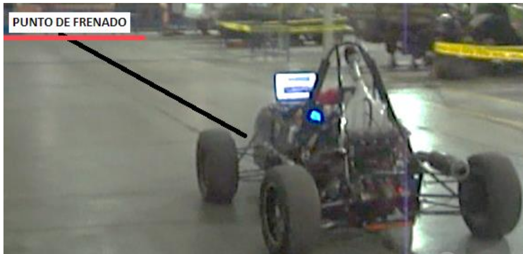
Figura 4. 4. Prueba de frenado del vehículo Formula SAE
