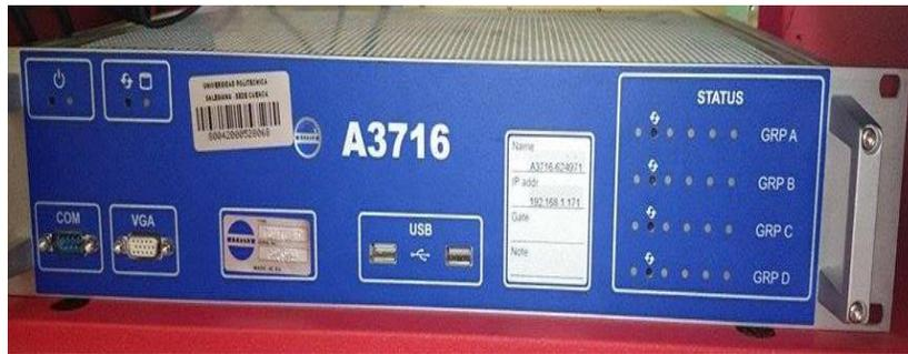
**Figura 2. 16:** Analizador de vibraciones ADASH módulo A3716.
