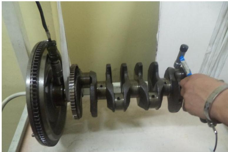
**Figura 3. 6:** Cigüeñal y volante a noventa grados con el acelerómetro en el punto B.
