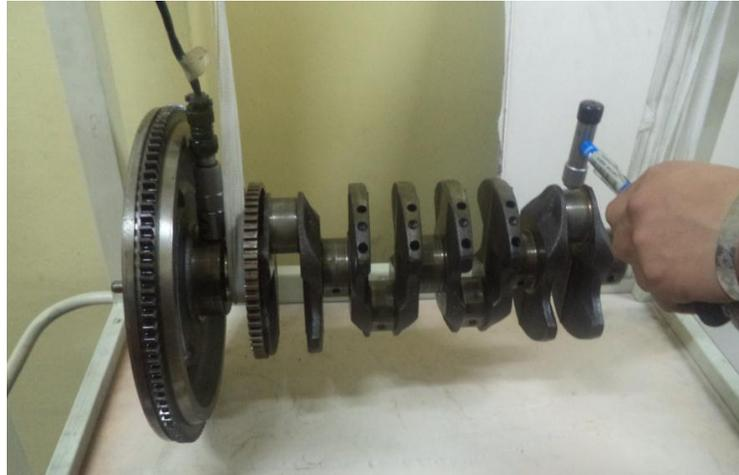
**Figura 3.5:** Cigüeñal y volante a cero grados con el acelerómetro en el punto B.
