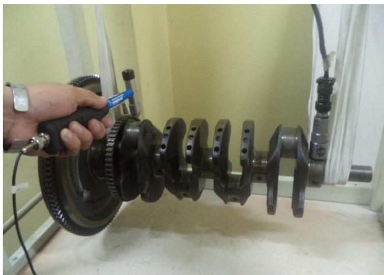
**Figura 3.1:** Cigüeñal y volante a cero grados con el acelerómetro en el punto A.
