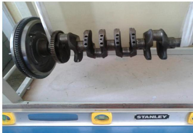
**Figura 2. 3:** Volante de inercia y cigüeñal nivelados
