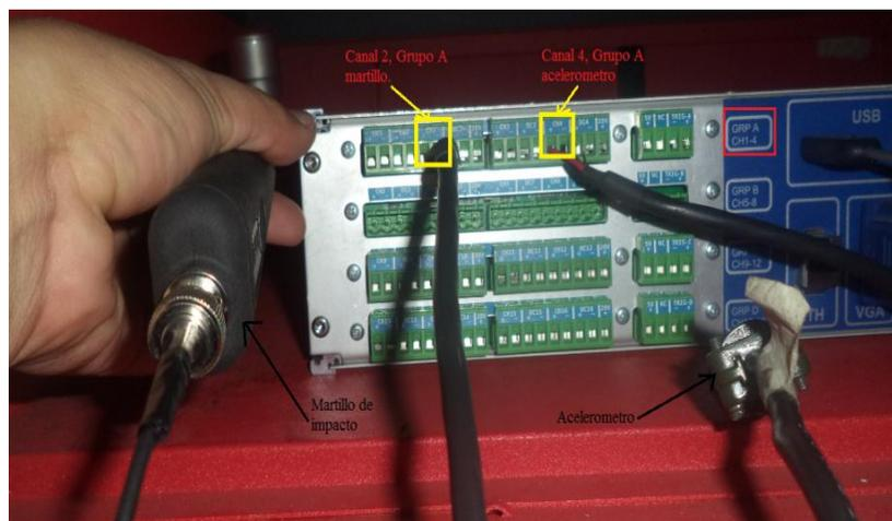
**Figura 2. 6:** Conexionado de los transductores
