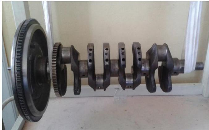
**Figura 2. 15:** Cigüeñal y volante de inercia posición libre-libre.
