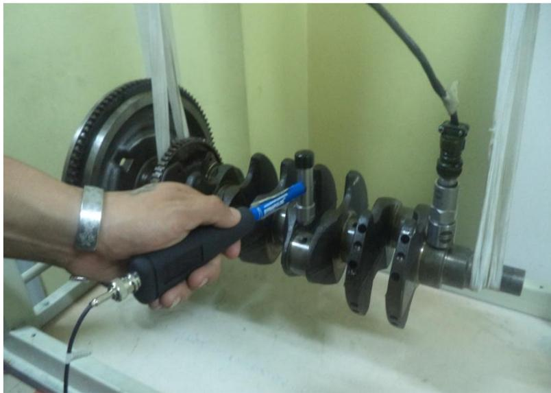
**Figura 3.2:** Cigüeñal y volante a noventa grados con el acelerómetro en el punto A.
