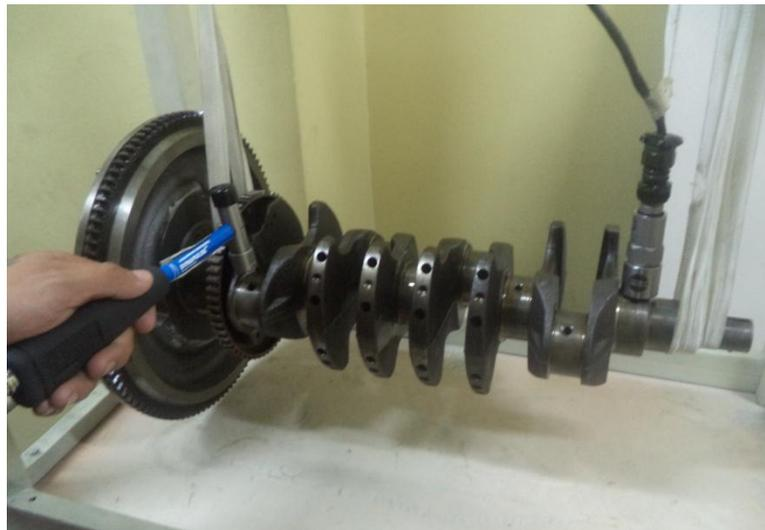
**Figura 3.4:** Cigüeñal y volante a doscientos setenta grados con el acelerómetro en el punto A.
