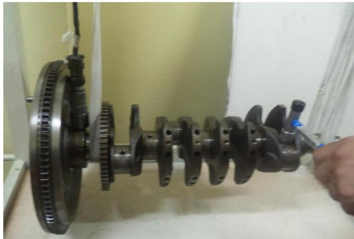
**Figura 3.8:** Cigüeñal y volante a doscientos setenta con el acelerómetro en el punto B.
