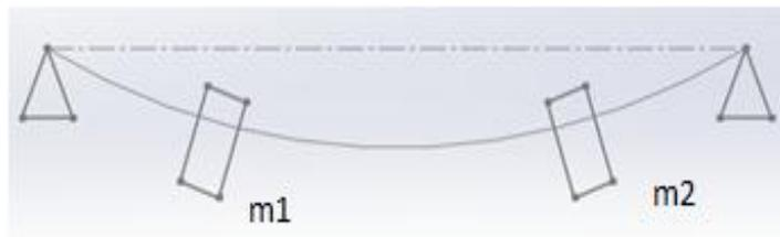
**Figura 1.26:** Deformación de un eje en la primera velocidad crítica.
