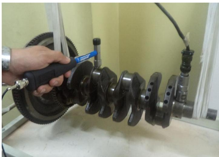
**Figura 3.3:** Cigüeñal y volante a ciento ochenta grados con el acelerómetro en el punto A.
