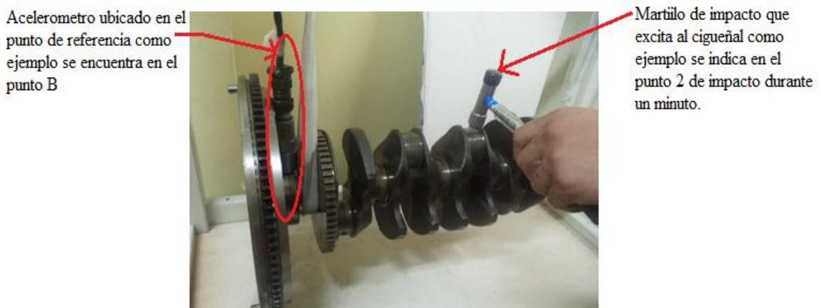
**Figura 2. 11:** Excitación del volante de inercia y cigüeñal durante 1 minuto.
