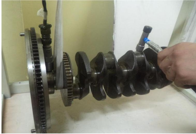
**Figura 3.7:** Cigüeñal y volante a doscientos ochenta grados con el acelerómetro en el punto B.
