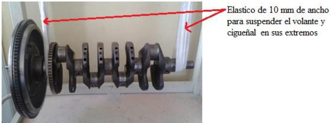
**Figura 2. 2:** Volante de inercia y cigüeñal suspendidos
