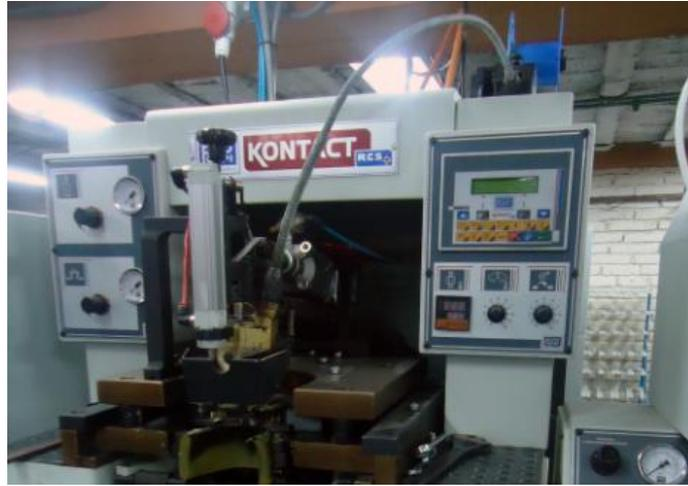
**Figura 125.** *Máquina Armadora de Talones COMINCALZA.*
