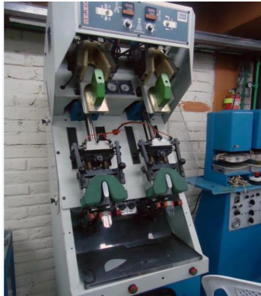
**Figura 126.** *Máquina Conformadora de Talones COMINCALZA.*
