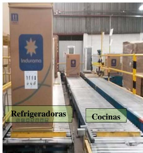
**Figura 1.4** . Línea de ingreso de producto terminado, de refrigeradoras y cocinas
