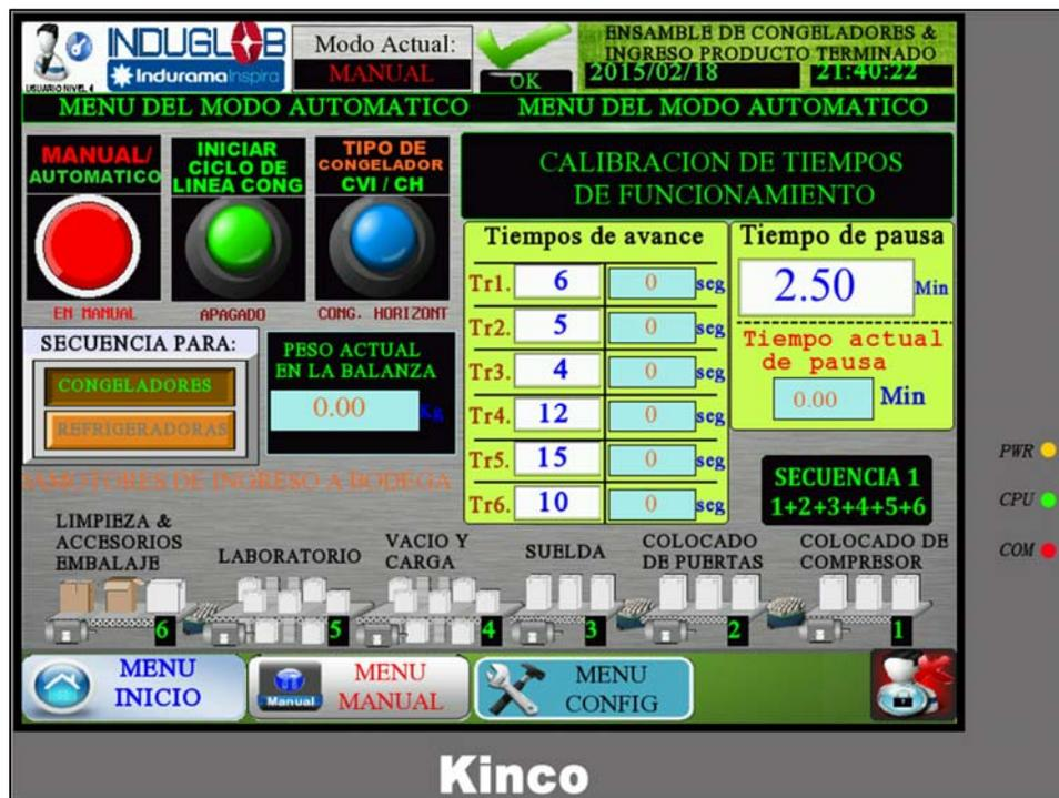
Figura 4.20 Ejemplo de la HMI programada, en este caso del menú Automático
