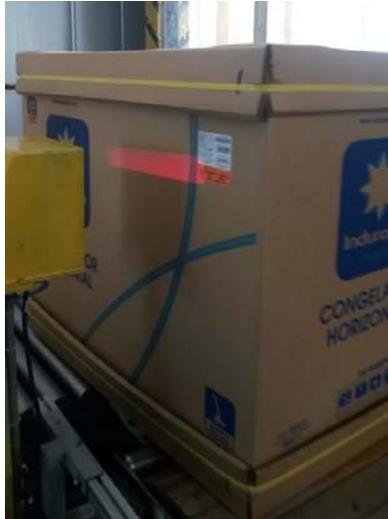
**Figura 5.25** Producto ingresando al proceso de validación, se lee el código de barras del producto
