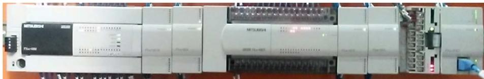
**Figura 4.2** Distribución física del PLC, módulos de expansión y módulos especiales
