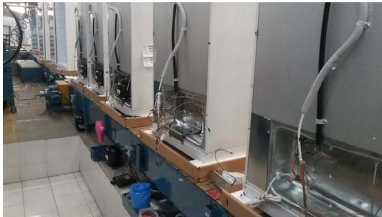
**Figura 5.16** Banda donde se realiza el subproceso “colocado del compresor”
