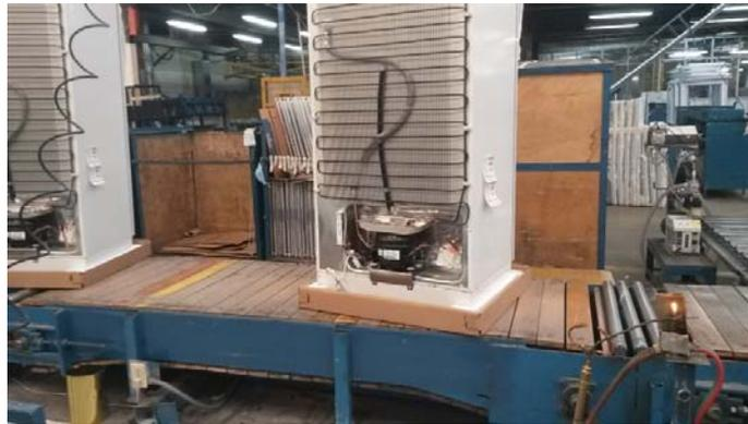
**Figura 5.18** Banda donde se realiza el proceso “Soldadura de cañerías”
