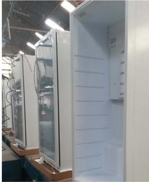
**Figura 5.17** Banda donde se realiza el subproceso “Colocado de puerta”
