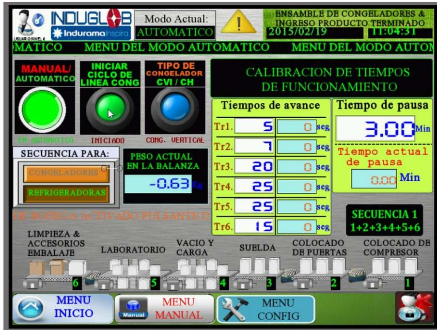
Figura 5.6 HMI seleccionando el modo automático e inicio de ciclo
