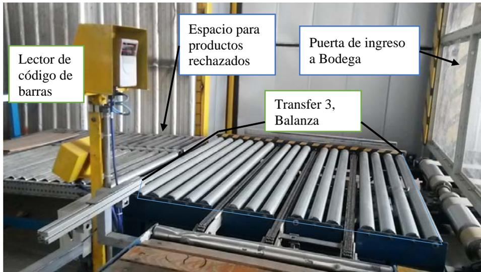
**Figura 4.11** Puesto para la validación del producto terminado, transfer 3
