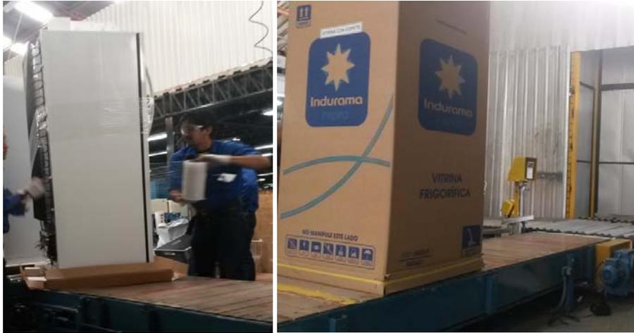
**Figura 5.21** Banda donde se realiza el subproceso “Embalaje”
