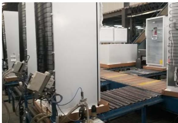
**Figura 5.19** Banda donde se realiza el subproceso “Vacío y carga”
