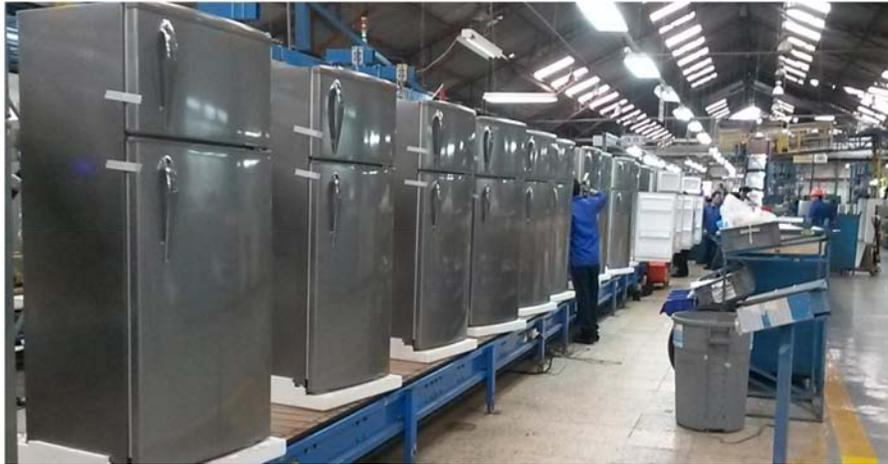
**Figura 1.3** Línea de ensamble de Refrigeradoras
