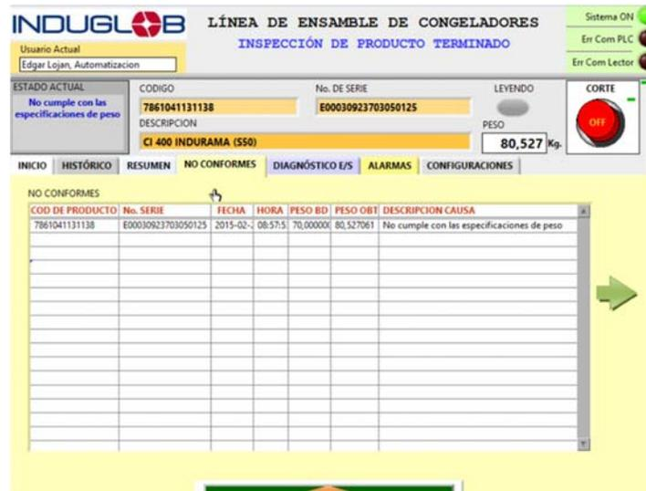
Figura 5.28 Validación del producto terminado, no cumple especificaciones de peso
