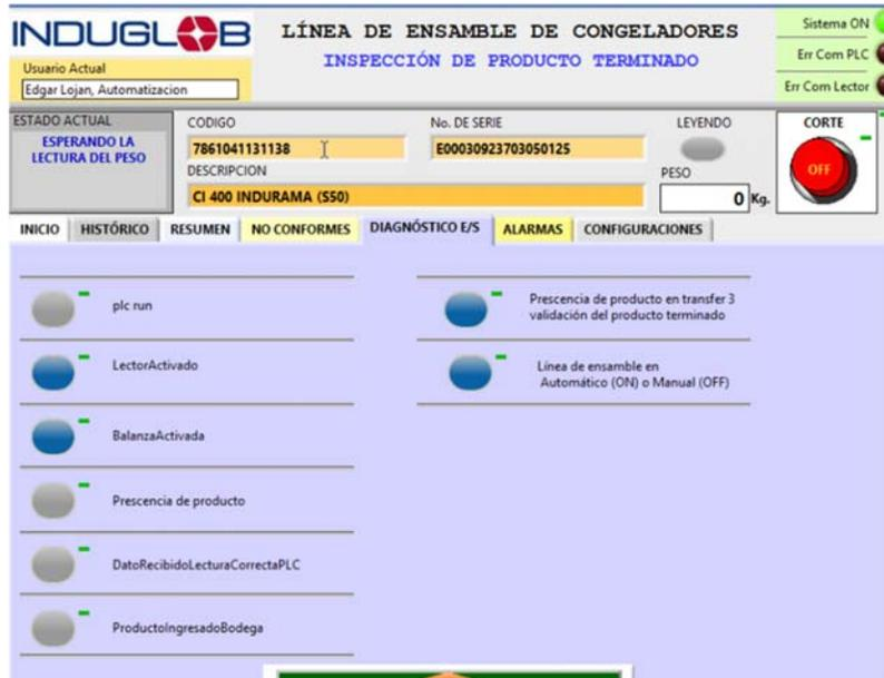
Figura 5.27 Aplicación de validación del producto terminado, ha leído el código de barras y está en espera de la lectura del peso del producto
