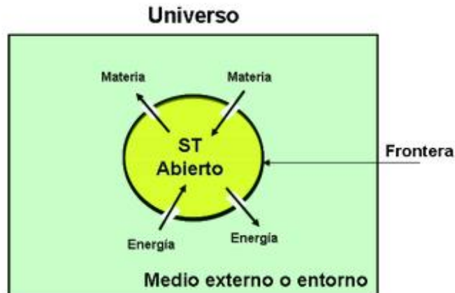
Figura 1. 2 Sistema termodinámico abierto. Fuente: [4]
