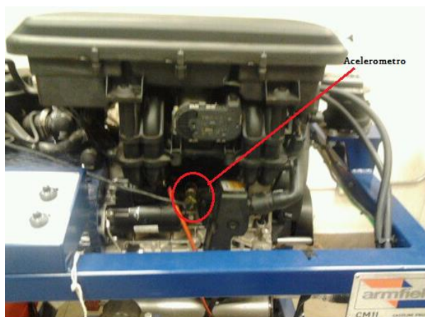
Figura 2. 5 Ubicación del Acelerómetro sobre el Knock Sensor. Fuente: Autores
