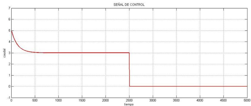
**Figura 30:** Señal de control ante la falla 2
