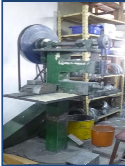
*Ilustración 58. Riesgo por Maquinaria Desprotegida en el Área de Remachado.*
