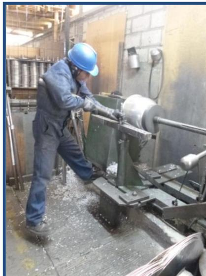
*Ilustración 12. Operario Realizando el Repujado de una Olla de Aluminio.*
