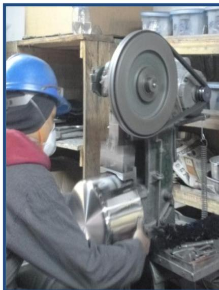
*Ilustración 15. Perforado de una Olla de Aluminio.*
