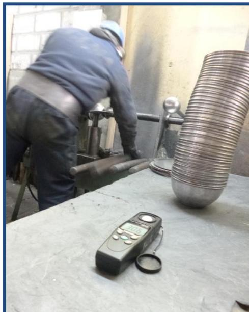
*Ilustración 52. Medición de Nivel de Luz en el Área de Repujado.*
