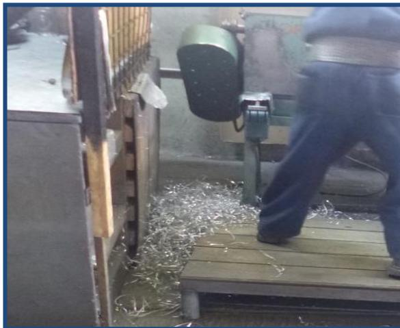
*Ilustración 62. Limalla Procedente del Proceso de Repujado (Riesgo por Proyección de Sólidos).*
