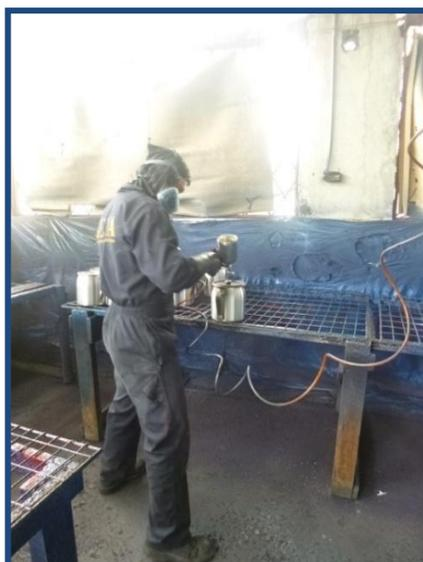
*Ilustración 29. Pintado por Pulverización en el que las Partículas de Pintura Flotan.*
