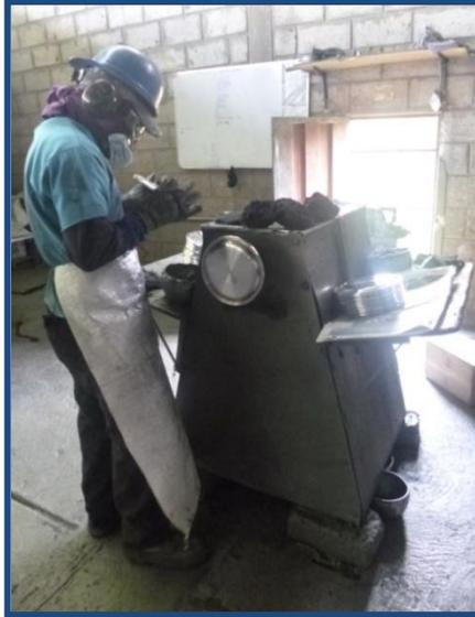
*Ilustración 14. Operario Realizando el Abrillantado de un Artículo de Aluminio.*
