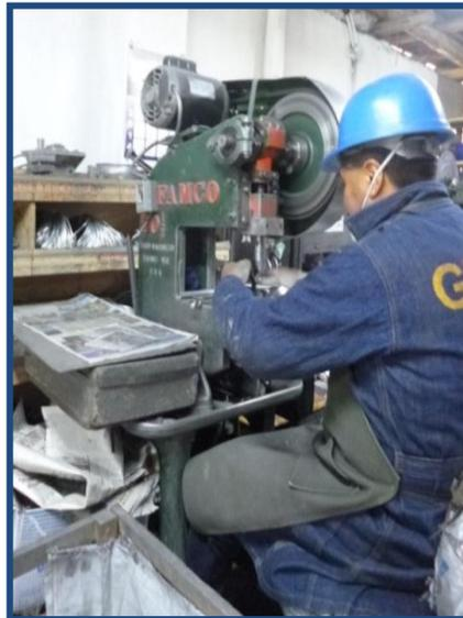
*Ilustración 16. Operario Realizando el Remachado en un Artículo de Aluminio.*
