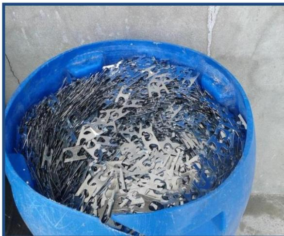
*Ilustración 24. Contenedor donde Almacenan los Residuos Generados en el Troquel.*
