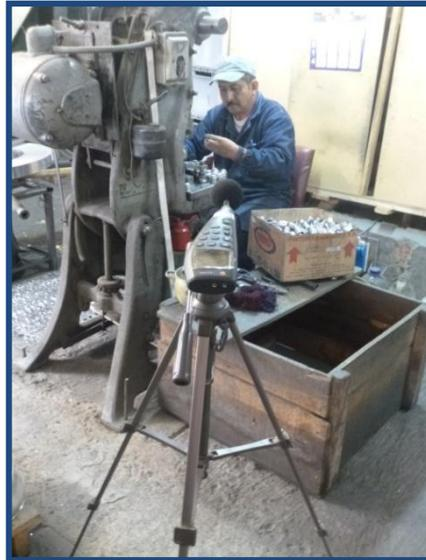
**Ilustración 50.** Medición de Ruido en el Área de Troquelado.
