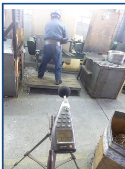
**Ilustración 49.** Medición de Ruido en el Área de Repujado.
