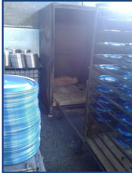
*Ilustración 19. Tapas Listas para Introducir al Horno.*
