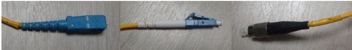
Figura 4.18: Terminales de patchcords SC, LC, FC
