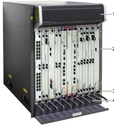
Figura 4.4: Vista frontal de componentes del equipo NE40E-X8
