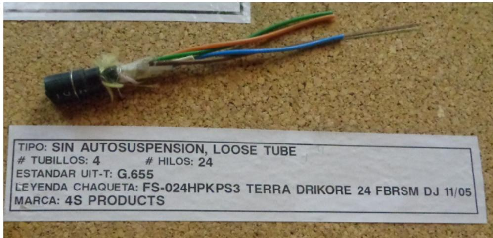
Figura 4.14: fibra sin autosuspension de 24 hilos tipo g.655
