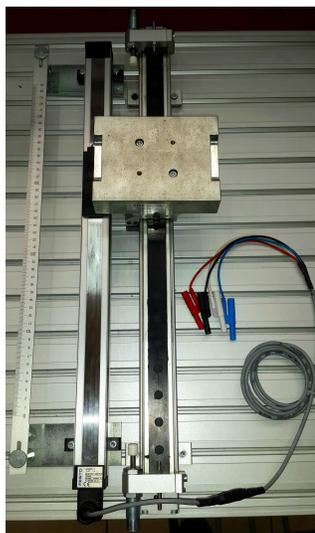
Figura 1.7: Potenciómetro y Actuador Lineal para el sistema neumático.
