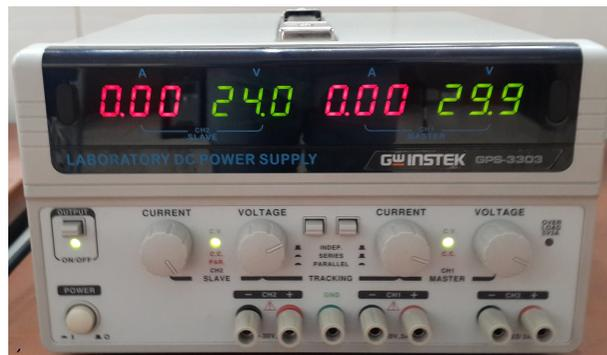
Figura 1.15: Fuente de tensión variable para la señal de referencia del sistema neumático.
