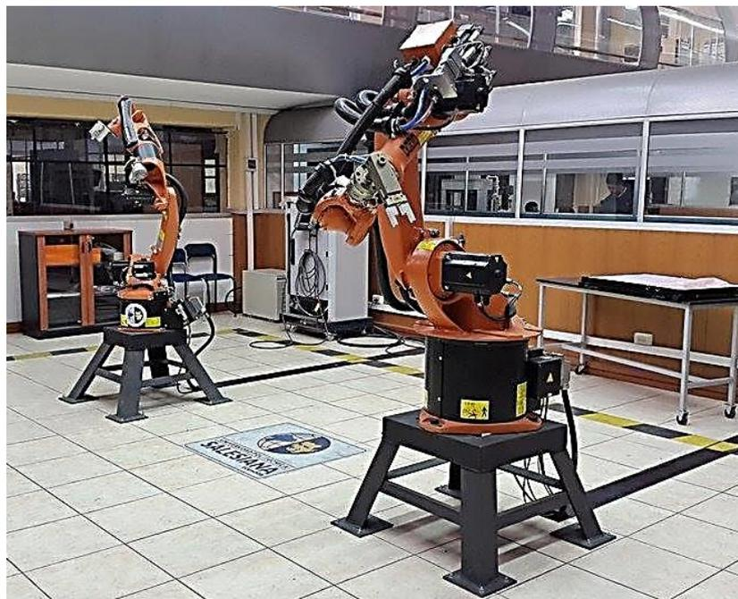
**Figura 14.** Robots KUKA KR 5-2 ARC HW y KR 16-2 en el laboratorio de robótica
