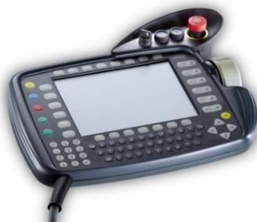
**Figura 12.** Unidad de control para sistemas industriales KUKA [4]
