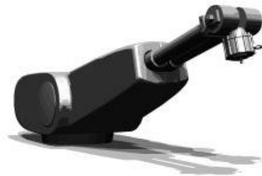
**Figura 1.** Brazo robótico esférico Unimate [1]
