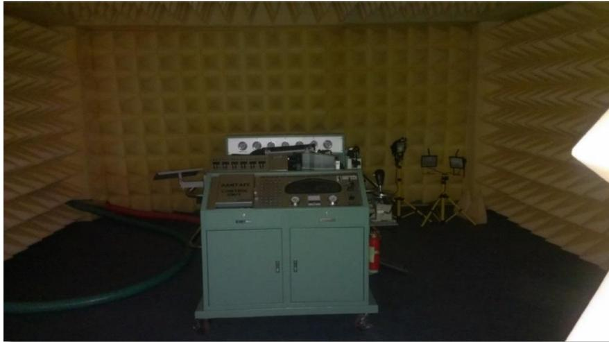
**Figura 3. 5** Motor ubicado en la cámara anecoica para la toma de muestras. **Fuente:** Los autores
