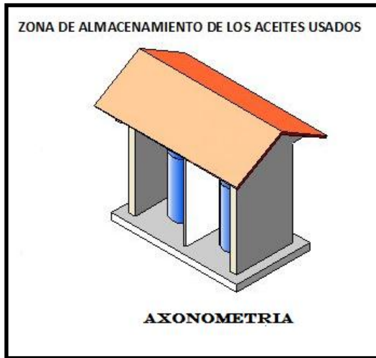
Figura 39. Axonometría Zona de Almacenamiento de los Aceites Usados Fuente: Los Autores
