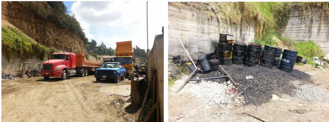
Figura 29. Taller con un deplorable almacenamiento de aceite usado Fuente: Los Autores
