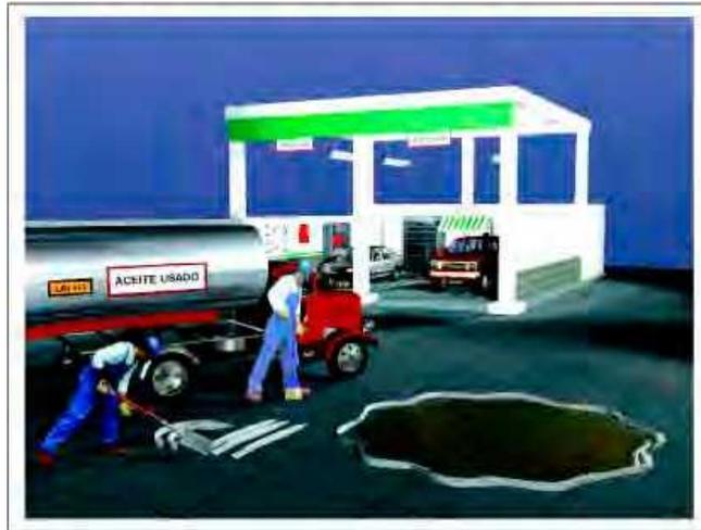
*Figura 4.5: material oleofílico para el control de goteos*
