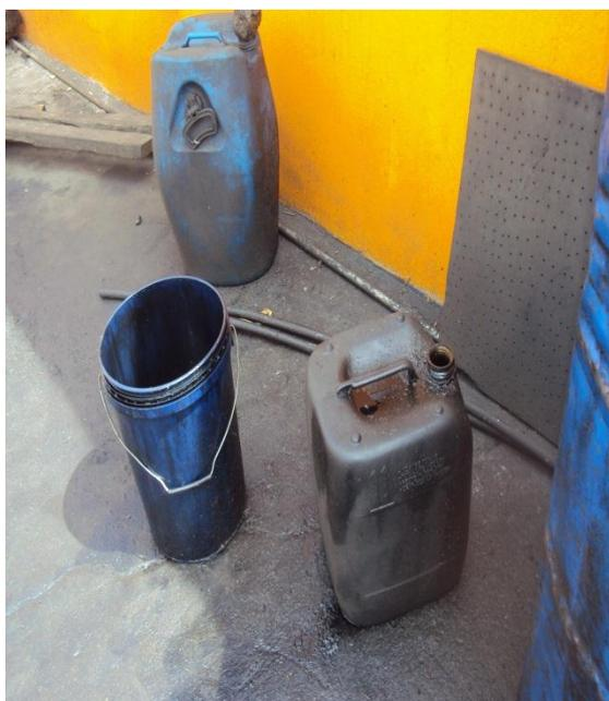
*Figura 2.22: Taller mecánico Astudillo, recipientes inadecuados destinados para el almacenamiento del aceite por los cuales se produce el derrame.
