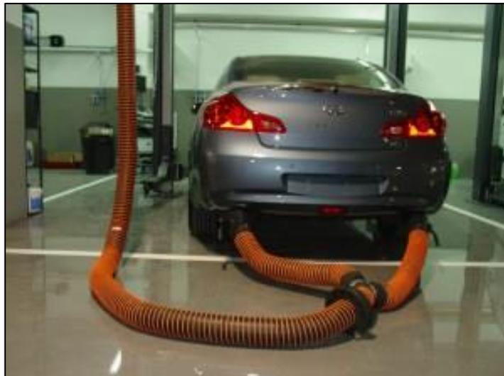
**Figura 2.7** Extractores de humos de los gases de escape.
