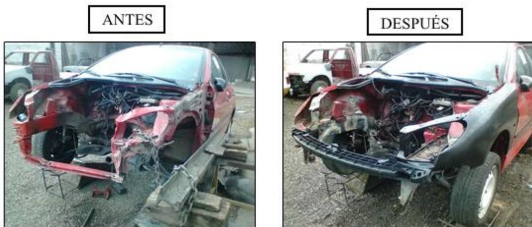
**Figura 1.11** L para enderezado de compactos
