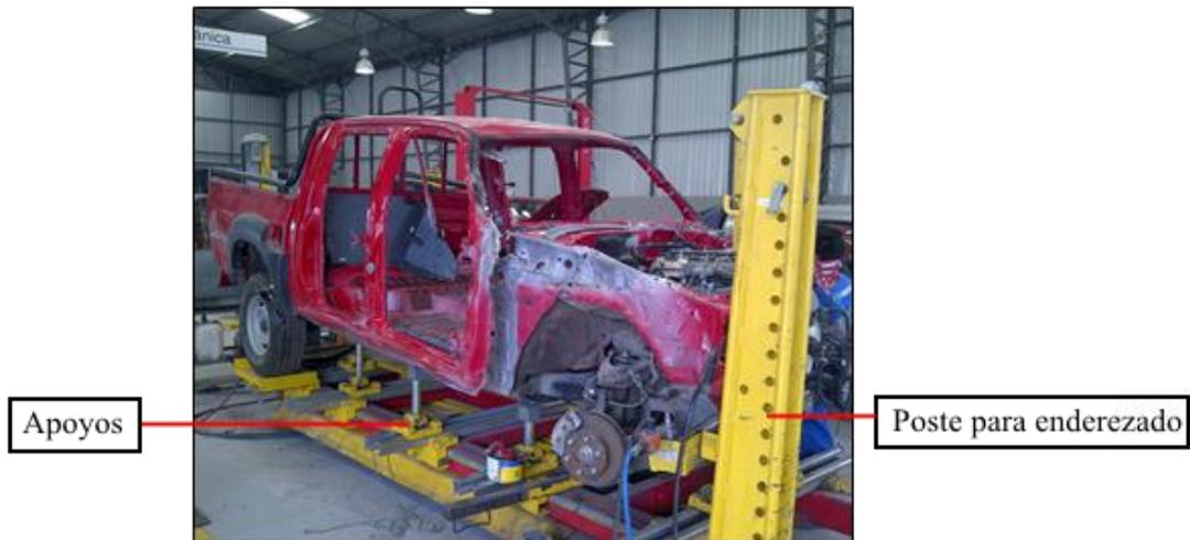
**Figura 1.2** Cama para enderezado de chasis y compactos
