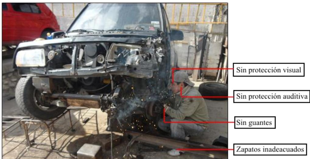
**Figura 3.6** Inadecuación indumentaria y equipos de seguridad del personal
