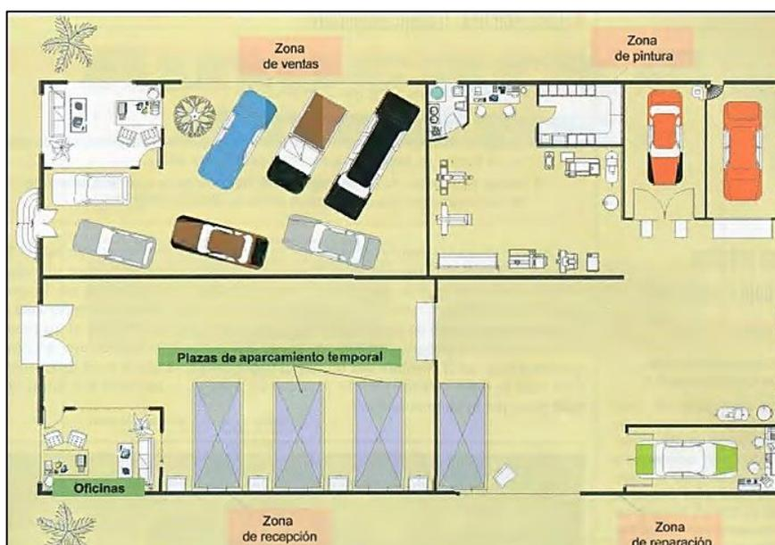
**Figura 2.11** Planta de taller de carrocería
