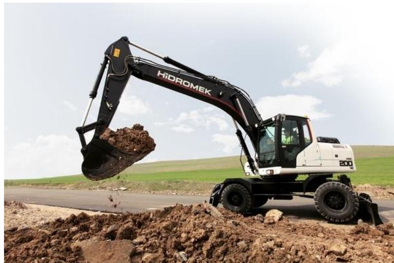
**Figura 3. 7:** Excavadora sobre ruedas. Fuente:[16]
