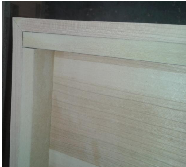
Figura 3.15 Tablero armado con folding
