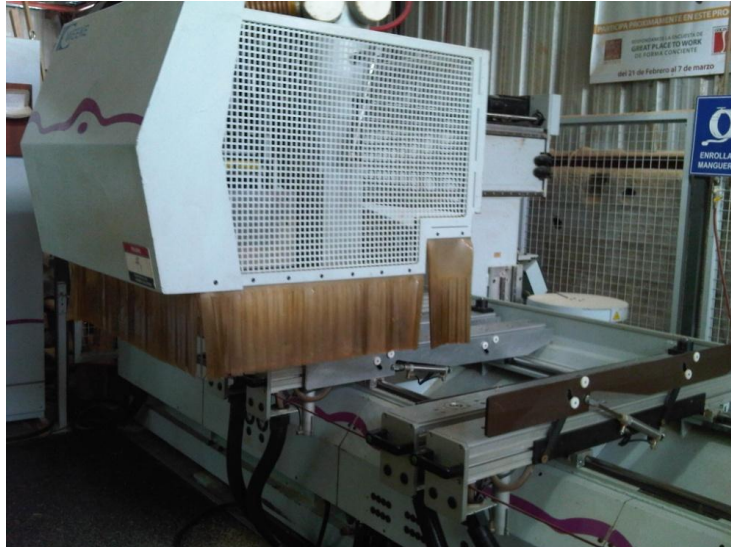
Figura 1.32 Centro de mecanizado BP-120
