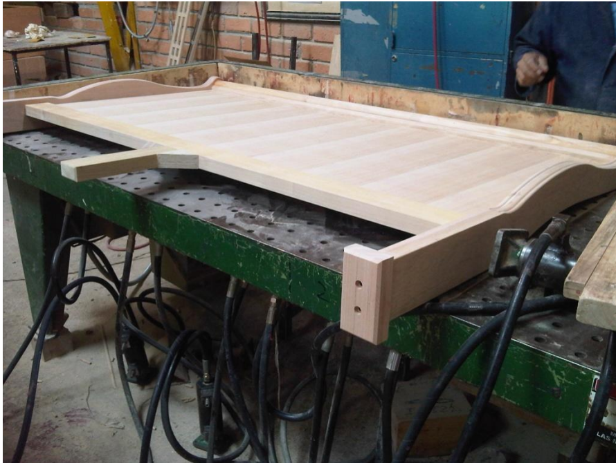
Figura 1.33 Prensa de subconjuntos
