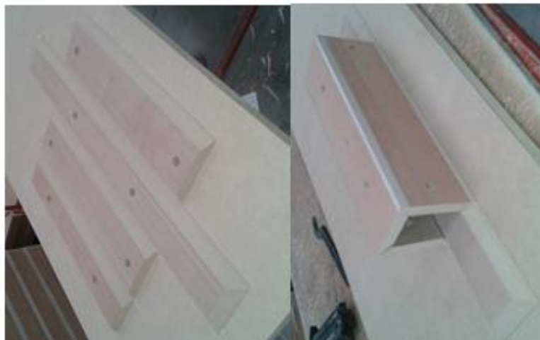
Figura 3.16 Tablero armado con folding antes y después de armado
