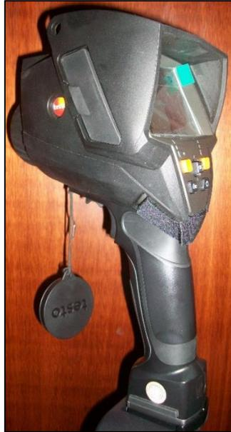
Figura 2.9: Cámara termográfica TESTO 882.
