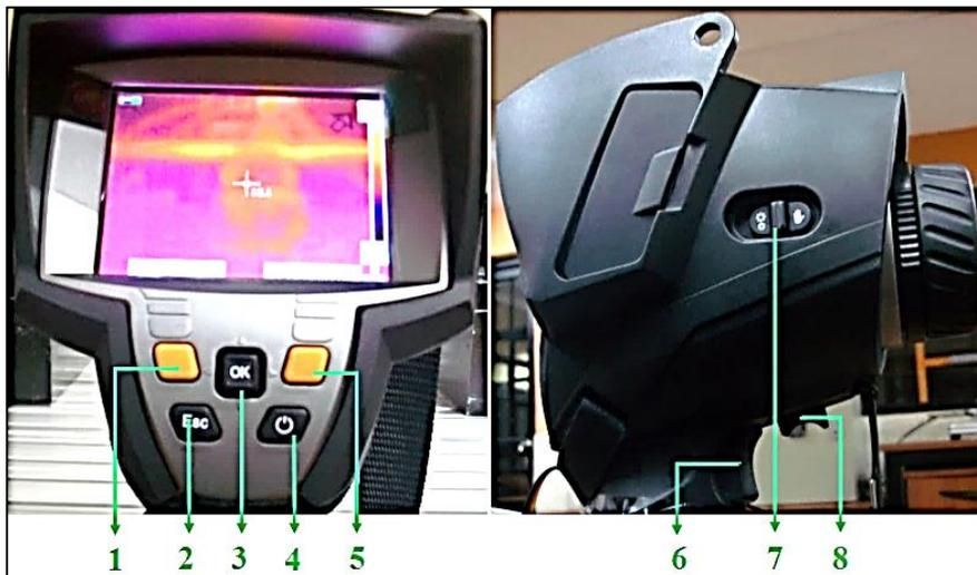
Figura 5.3: Disposición de botones en el panel de control del equipo Testo 882.
