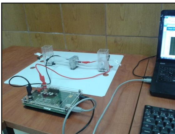
Figura 3. 22: Conexión del electrolizador al USB-data monitor
