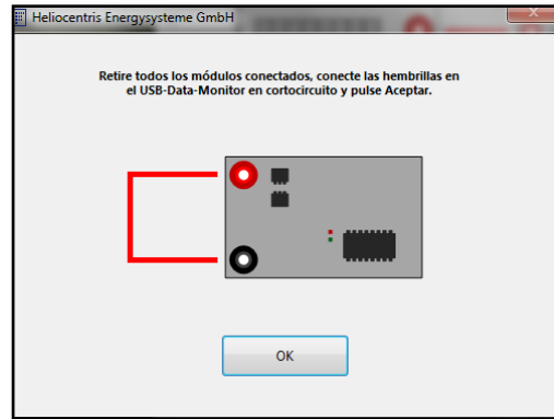
Figura 3. 18: Conexión en cortocircuito del software
