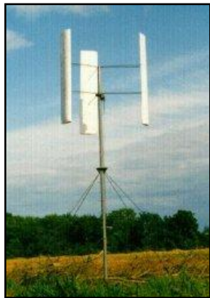
Figura 2. 5: Aerogenerador Tipo Giromill. [10] Figura 2. 6: Aerogenerador Tipo Windside. [10]
