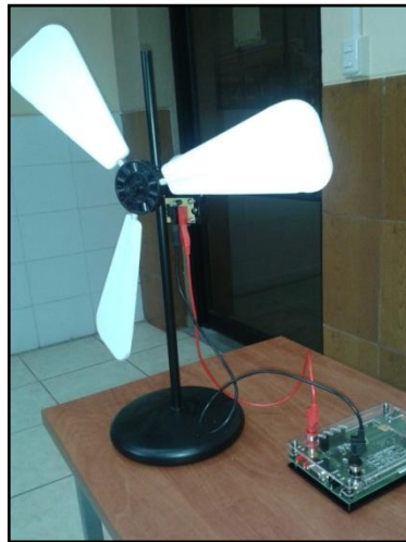
Figura 2. 23: Conexión del aerogenerador eólico al USB-data monitor
