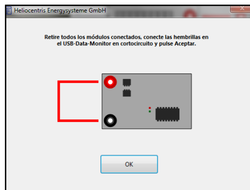
Figura 4. 4: Conexión en cortocircuito del software
