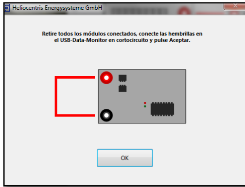
Figura 2. 18: Conexión en cortocircuito del software
