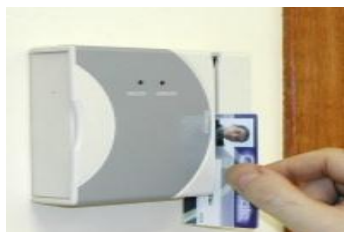
Figura 10. Lector de banda magnética interface RS-232 que incorpora relé
