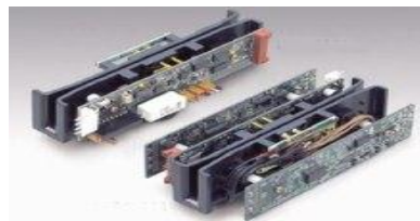
Figura 19. Lector / grabador de tarjetas con banda magnética Hi & Lo Co conexión TTL
