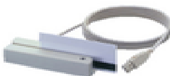
Figura 8. Lector de banda magnética USB emulación teclado o RS-232
