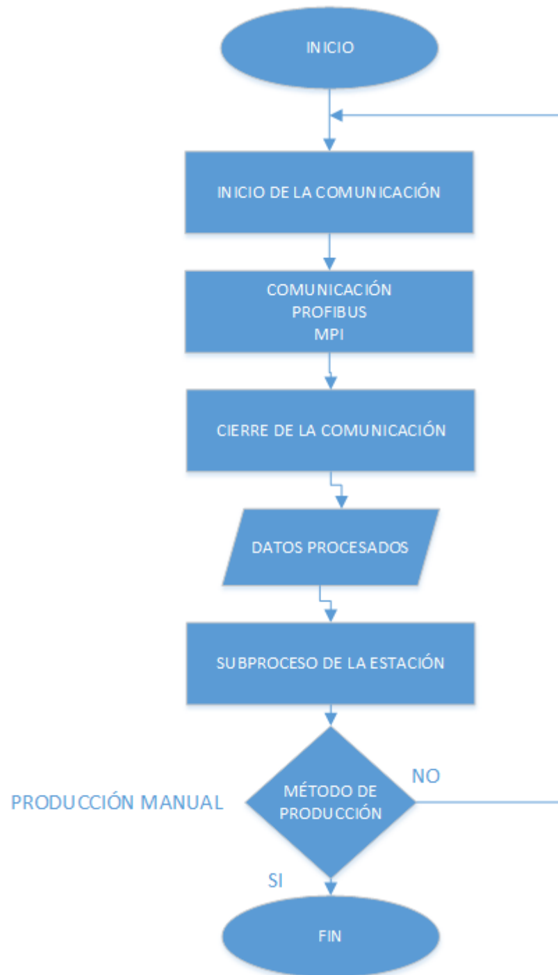
Figura 10. Diagrama de flujo programa PLC 3
