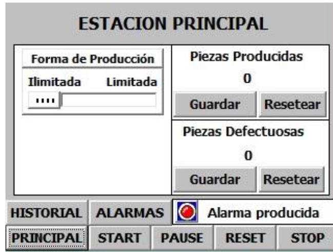
Figura 16. Pantalla panel operador
