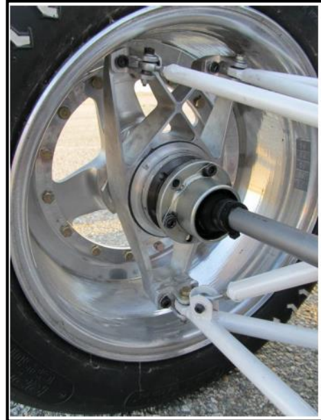
Figura 1.6. Ensamble de la rueda trasera con eje de transmisión y brazos de suspensión.
