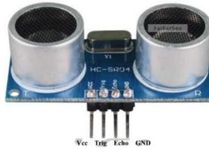
**Figura 2.12.** Sensor de Ultrasonido[48]
