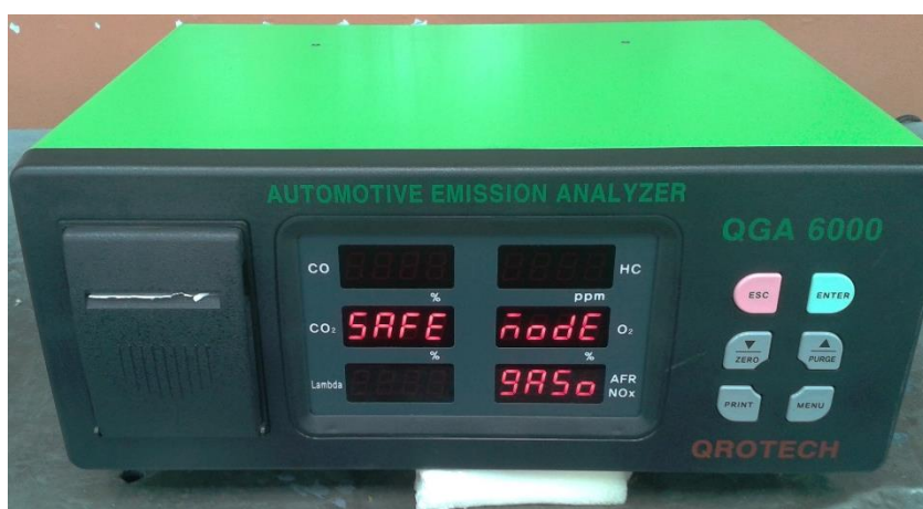
Figura 4.14 Analizador de gases QGA 6000 Fuente: Autores.
