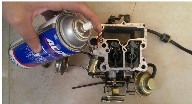
Figura 4.8 Limpieza del carburador Fuente: Autores.
