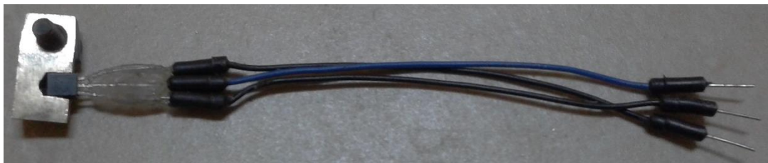
Figura 3.24 Encapsulado del LM35 Fuente: Autores.
