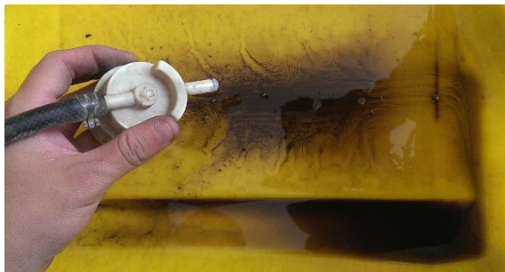
Figura 4.11 Filtro de combustible sucio Fuente: Autores.
