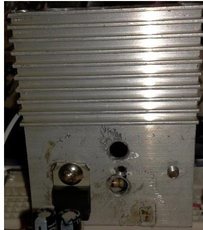
Figura 3.18 Disipador de calor del LM7805 Fuente: Autores.
