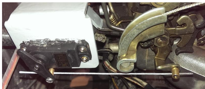
Figura 3.30 Cable de acero inoxidable uniendo el servomotor con la mariposa de aceleración
