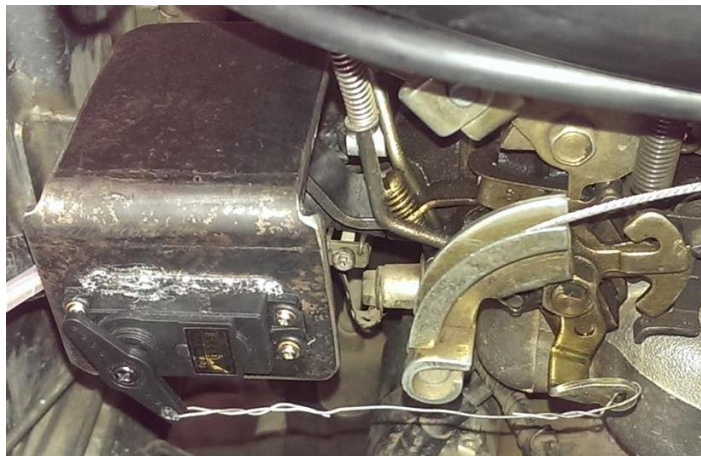
Figura 3.28 Cable conectando al servomotor con la mariposa de aceleración Fuente: Autores.
