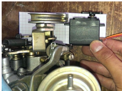
Figura 2.13 Medida de la posición del servomotor
