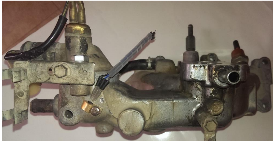
Figura 3.25 Sensor fijo al múltiple de admisión Fuente: Autores.
