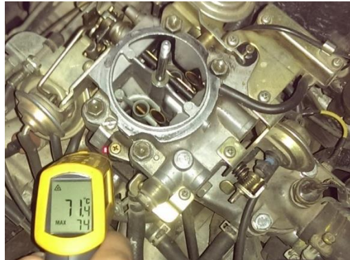
Figura 2.27 Temperatura del carburador con el motor caliente Fuente: Autores.
