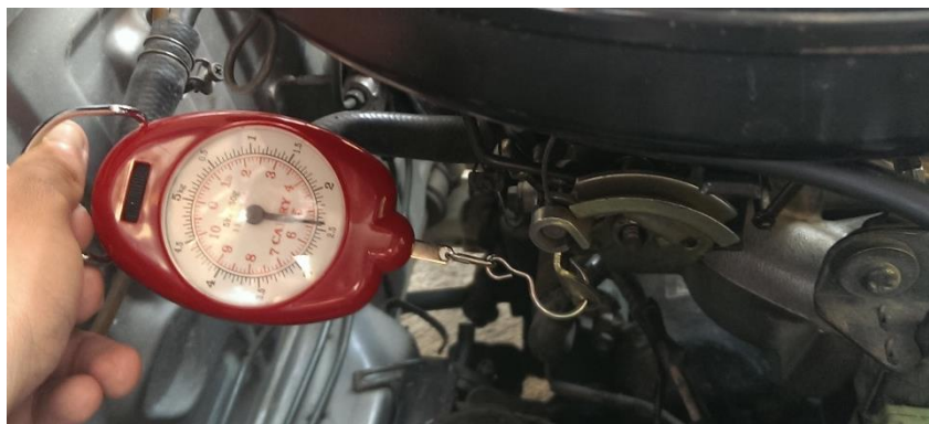
Figura 2.2 Fuerza requerida para mover la mariposa de aceleración Fuente: Autores.
