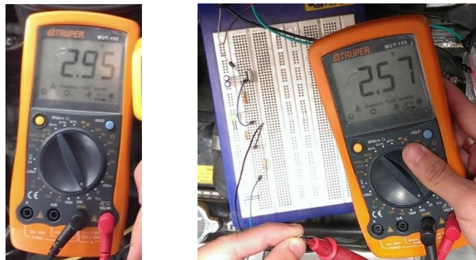
Figura 3.4 Voltaje del termo switch con el motor frío y caliente respectivamente Fuente: Autores.
