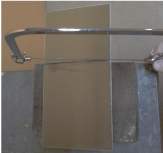
Figura 3.57 Recorte de la placa de cobre con fibra de vidrio Fuente: Autores.
