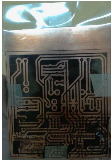
Figura 3.60 Acetato sujeto a la placa Fuente: Autores.
