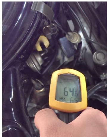
Figura 3.26 Temperatura que alcanza el LM35 con el motor caliente Fuente: Autores.
