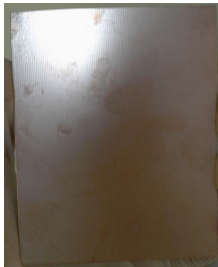
Figura 3.58 Placa recortada y con suciedad Fuente: Autores.
