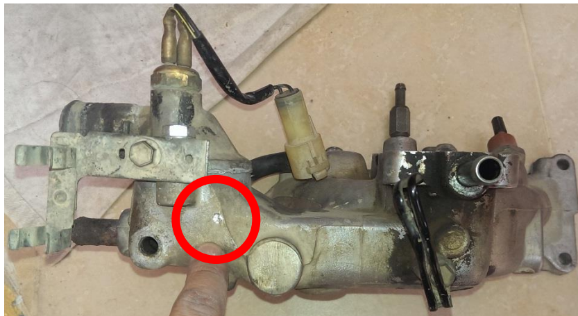
Figura 3.21 Zona para colocar el LM35 Fuente: Autores.
