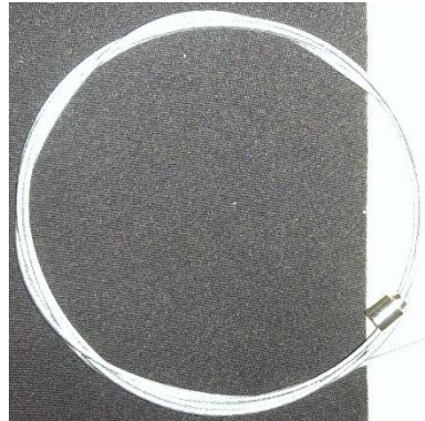
Figura 2.36 Cable de unión para el servomotor con la mariposa Fuente: Autores.
