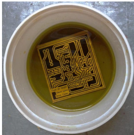
Figura 3.66 Placa sumergida en el ácido
