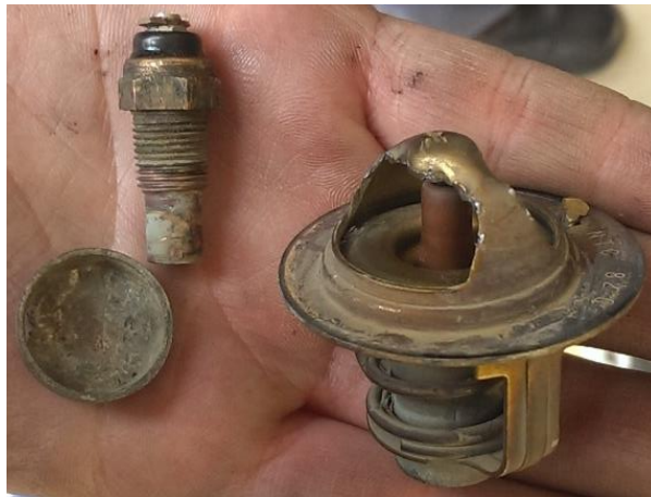
Figura 4.6 Elementos del sistema de refrigeración en mal estado Fuente: Autores.
