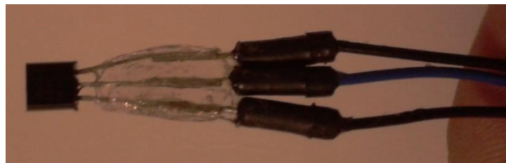
Figura 3.23 Pines del LM35 aisladas con silicón Fuente: Autores.
