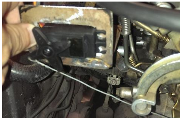
Figura 2.22 Prueba de giro del servomotor Fuente: Autores.
