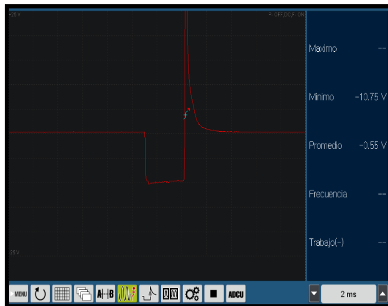
Figura 2.79. Grafica de la señal del inyector @4200. Fuente: Los Autores
