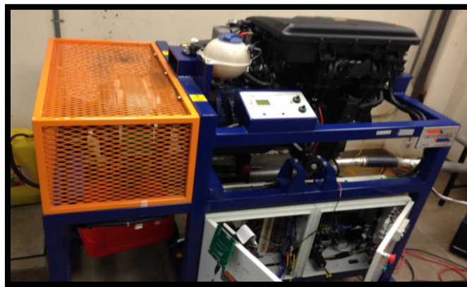
Figura 2.19. Banco dinamométrico Armfield Volkswagen CM11-306.
