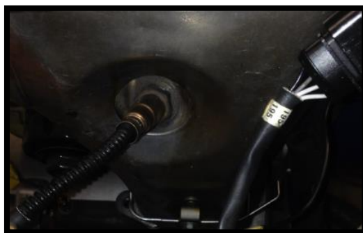
Figura 2.35. Medidor de oxígeno en el múltiple de escape.
