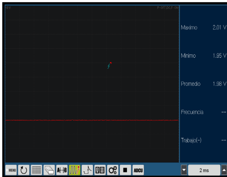
Figura 2.76. Grafica de la señal del sensor MAP @4200.
