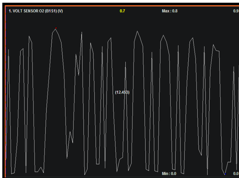
Figura 2.67. Grafica de la señal del O2 @3200. Fuente: Los Autores
