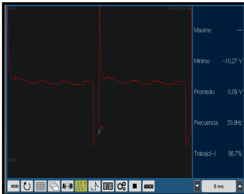
Figura 2.59. Grafica de la señal del inyector @2700. Fuente: Los Autores
