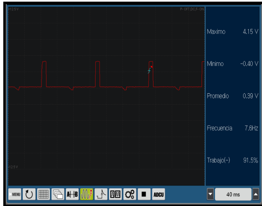
Figura 2.50. Grafica de la señal de la bobina. Fuente: Los Autores.
