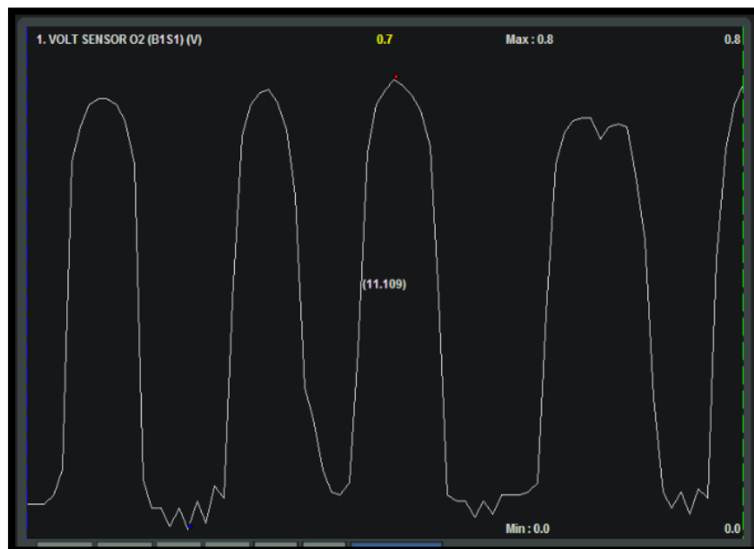
Figura 2.47. Grafica de la señal del sensor O2. Fuente: Los Autores
