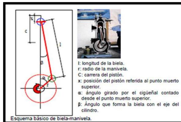
Figura 1.12. Esquema básico de biela-manivela.
