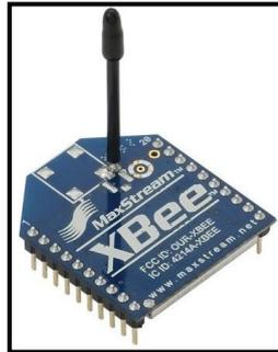
**Nota:** En esta gráfica se muestra el módulo XBEE.
