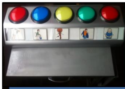
Ilustración 2 Tablero para niños con PCI en un ambiente adecuado [27]
