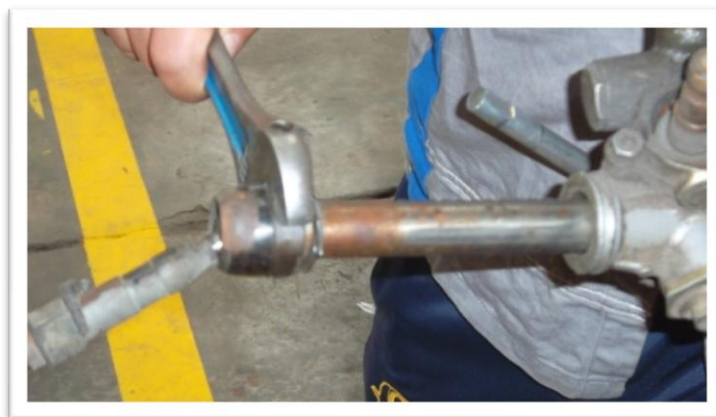
Figura 2.14 Remoción de la barra de acoplamiento Fuente: Autores
