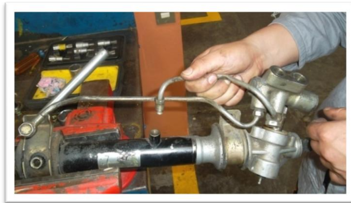
Figura 2.19 Desmontaje Conductos Fuente: Autores
