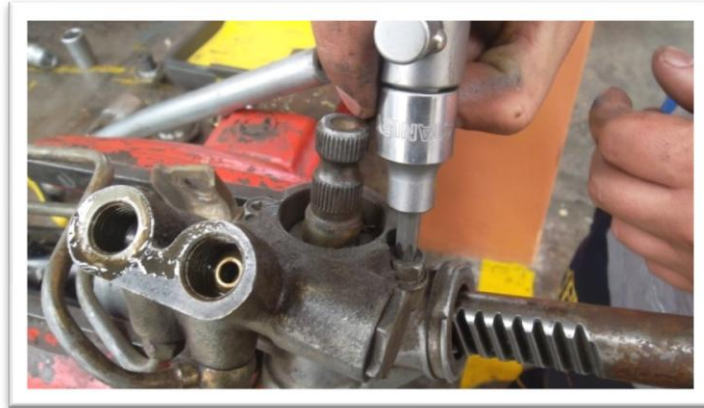
Figura 2.18 Desmontaje válvula distribuidora Fuente: Autores
