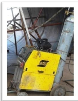
Figura 2.33 Soldadora MIG Fuente: Autores
