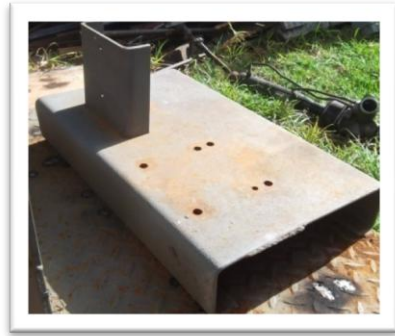
Figura 2.42 Base de la bomba de la dirección y el motor eléctrico Fuente: Autores
