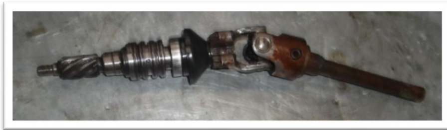
Figura 2.27 Conjunto tornillo sin fin y cruceta Fuente: Autores
