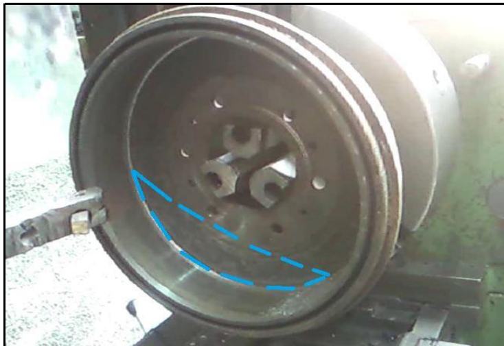
Figura2. 6 Seccionado de los tambores de freno Fuente: Autores
