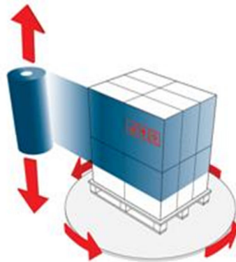
Figura 2.2: Esquema máquina envolvedora de plataforma giratoria 28
