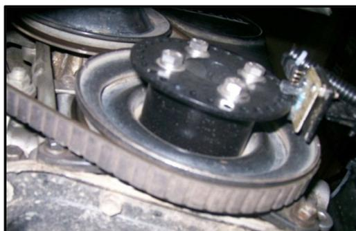
**Fig. 3.14. Sensor de RPM del motor de combustión interna y soporte.**
