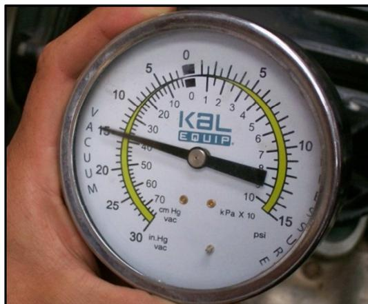
**Fig. 3.9. Medición del vacío generado por el motor.**
