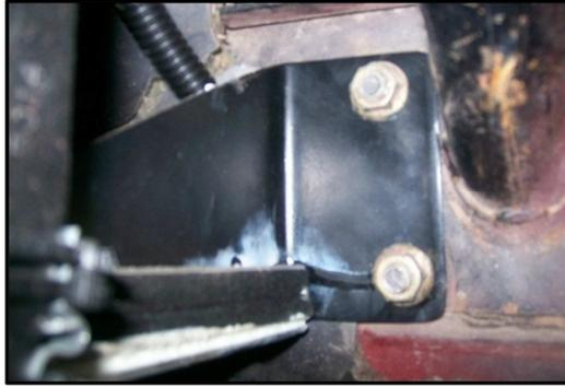
**Fig. 3.2. Sujeción del soporte hacia la carrocería.**
