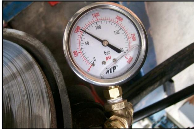
**Fig. 3.10. Medición de la presión hidráulica del circuito de frenos.**
