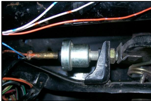
**Fig. 2.5. Interruptor del pedal de freno.**
