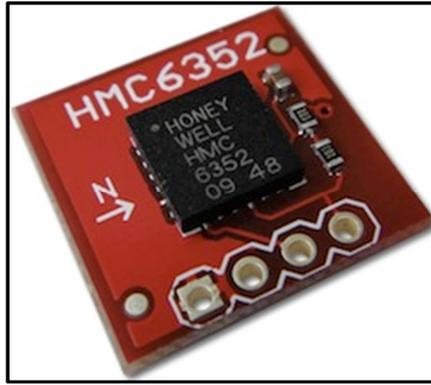
**Fig. 2.17. Módulo integrado magnetómetro HMC6352.**
