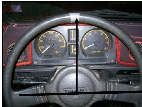
**Fig. 3.24. Medición del ángulo de giro del volante de dirección.**
