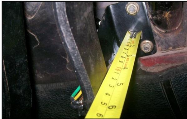
**Fig. 3.4. Medición del recorrido del pedal de freno.**
