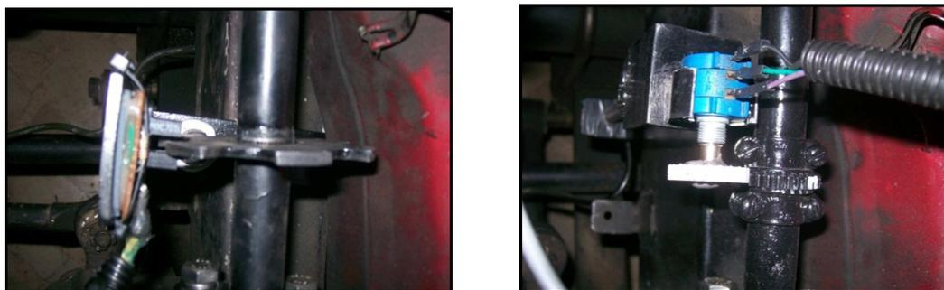
**Fig. 4.3. Reemplazo del sensor digital por un analógico tipo potenciómetro.**
