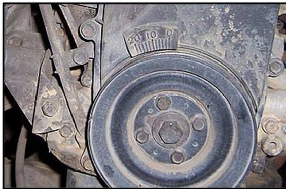
**Fig. 3.12. Polea del cigüeñal.**
