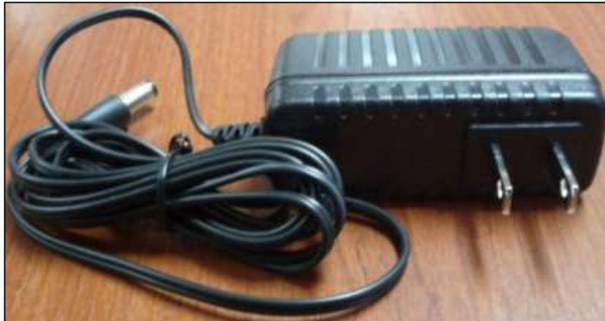
Figura 47. Adaptador de voltaje 120VAC/24VDC Omnitik.
