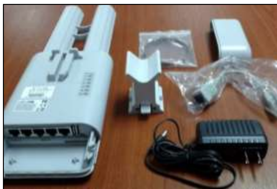
Figura 22. OmniTIK de Mikrotik (antena omnidireccional).
