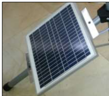
Figura 67. Instalación del panel solar en el trípode metálico.
