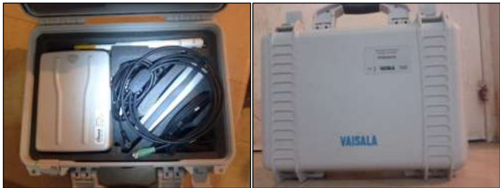
Figura 124. Estación meteorológica portátil Vaisala PTB330TS.
