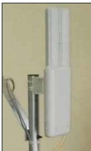
Figura 51. Antena Omnitik del lado de la BASE – modo AP bridge
