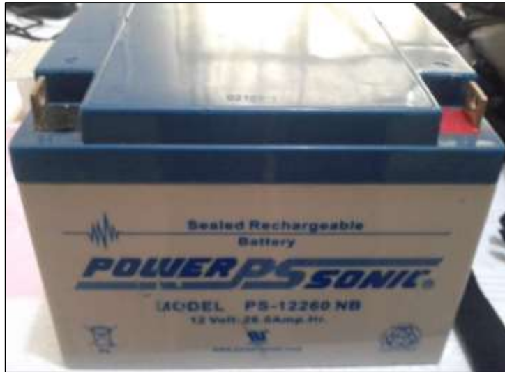
Figura 43. Batería recargable Power Sonic de 12 VDC a 26.0 Amp/Hr.
