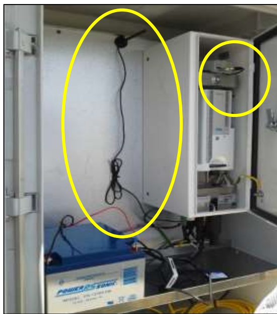
Figura 7. Estación Automática VAISALA, con transmisión GPRS.
