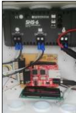
Figura 68. Colocación del controlador y las tarjetas electrónicas.
