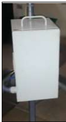
Figura 66. Caja metálica para el sistema controlador y la batería.
