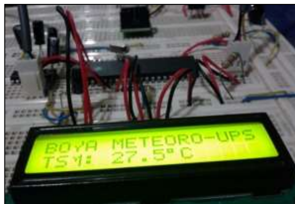
Figura 38. Pruebas de funcionamiento de los sensores y del microcontrolador PIC.
