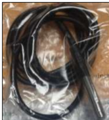
Figura 29. Sonda resistente al agua, que contiene el sensor de temperatura DS18B20.
