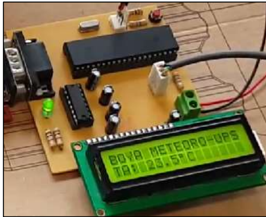
Figura 62. Tarjeta electrónica METEORO-UPS, para la adquisición de los datos meteorológicos de la estación acuática.
