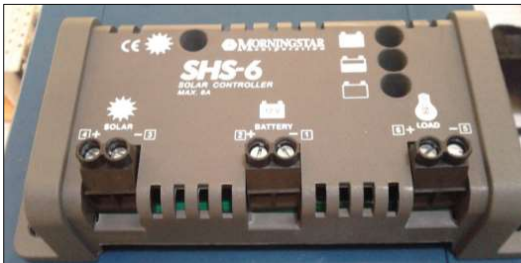
Figura 44. Controlador de carga MORNINGSTAR SHS-6.
