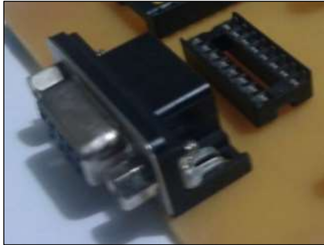
Figura 48. Módulo para el transceptor MAX232 y conector DB9
