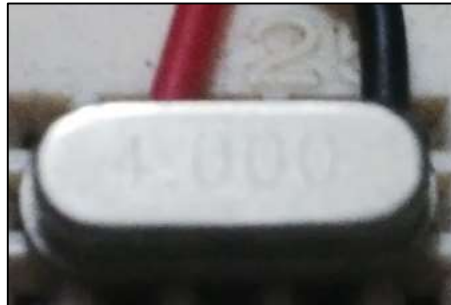
Figura 19. Cristal de cuarzo de 4 MHz.
