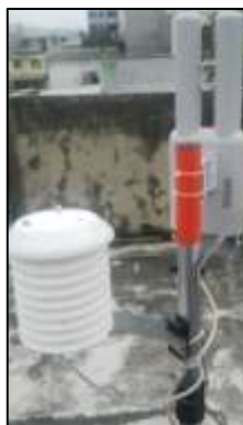
Figura 70. Colocación de la antena omnidireccional y la mini caseta meteorológica.
