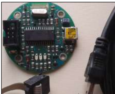
Figura 36. Quemador PIC, desarrollado por I&T 21
