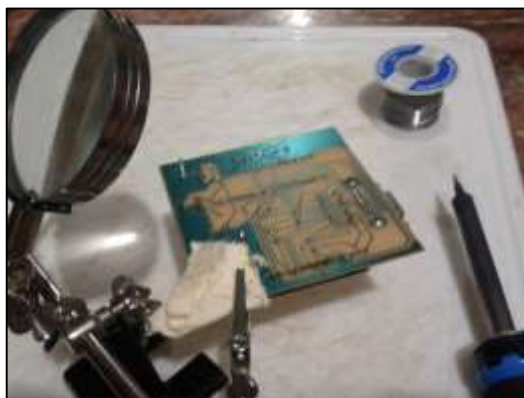
Figura 61. Soldadura de los elementos electrónicos de la tarjeta de adquisición de datos.
