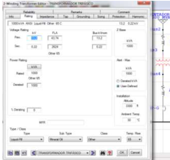
Figura 7.9 Configuración Transformador Trifásico (Potencia-Niveles de Tensión) Fuente: Los Autores
