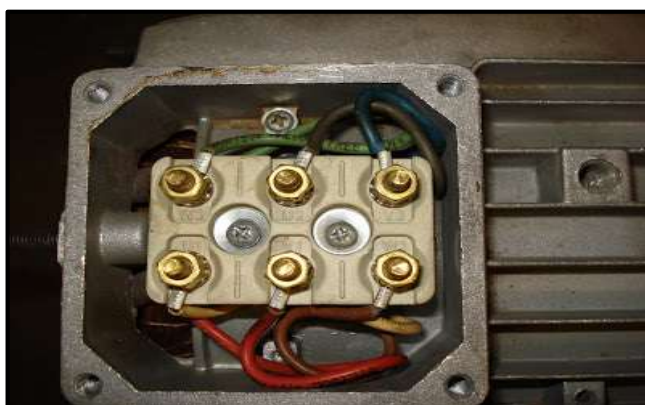
Ilustración 6 Conexión Interna de un Motor Trifásico
