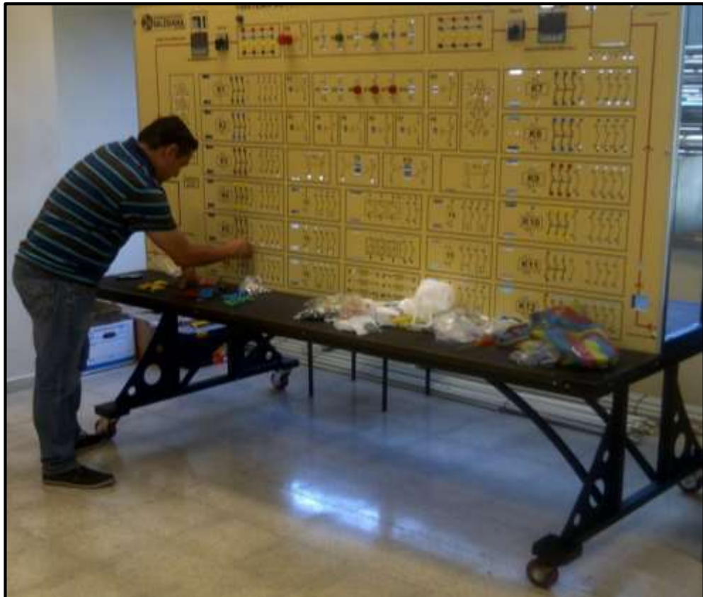
Ilustración 40 Colocación de borneras al banco
