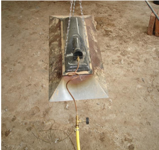
FOTO 1. 12■ criadora con piedras incandescentes
