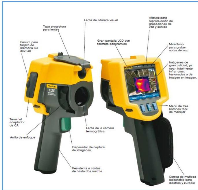
**Figura 14.** Cámara termográfica Ti25 [52]
