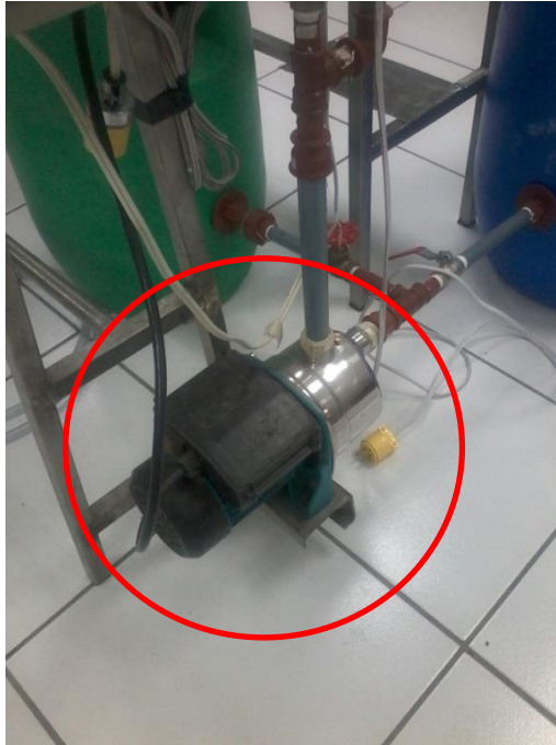
Ilustración 11. Bomba de agua adaptada al dispositivo.
