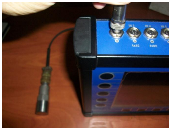
Figura 9. Conexión de acelerómetro en el analizador de vibraciones. Fuente: Los autores
