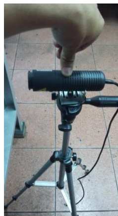
Figura 15. Montaje del tacómetro en el soporte. Fuente: Los autores
