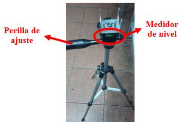
Figura 14. Nivelación del soporte del tacómetro. Fuente: Los autores
