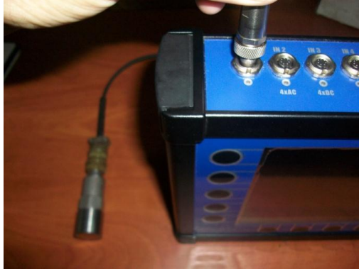
Figura 11. Conexión de acelerómetro en el analizador de vibraciones. Fuente: Los autores
