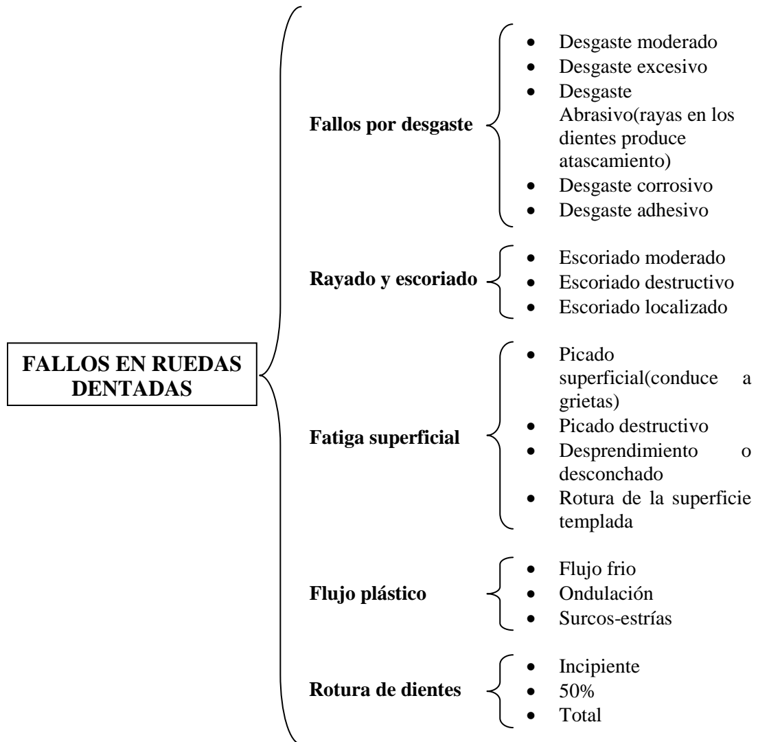
Figura 2.11. Tipos de fallos en ruedas dentadas. Fuente [44]
