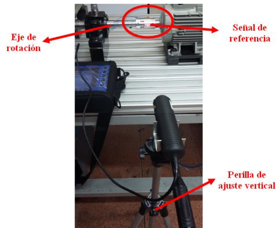
Figura 16. Fijación del laser en el punto de referencia al eje. Fuente: Los autores
