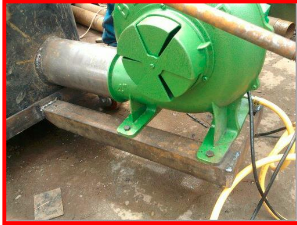
Figura 5.9. Construcción de placas para sistema de elevación de tapa.
