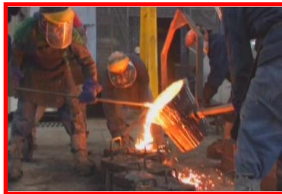
Figura 1.13. Colada de moldes.
