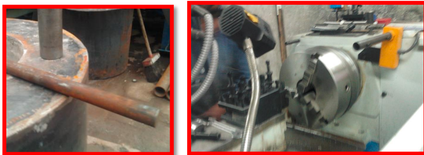
Figura 5.6. Construcción del eje para elevar la tapa.
