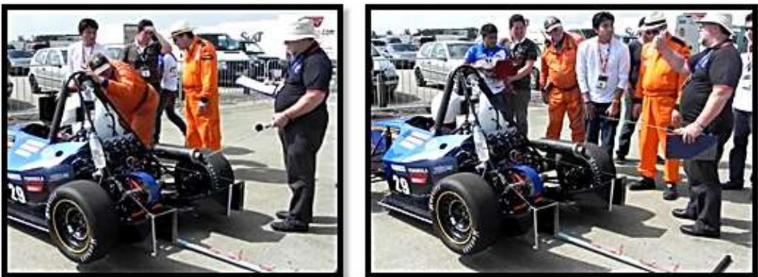
**Figura 4. 11.** Verificación del nivel de sonido del motor
