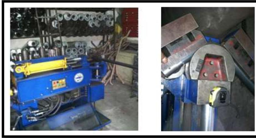
**Figura 3. 13.** Dobladora de tubos hidráulica
