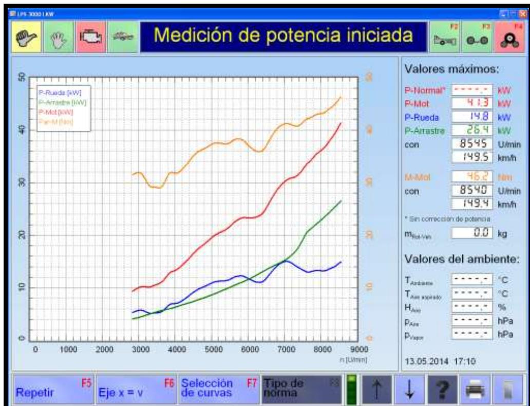
**Figura 4. 2.** Gráfica de la Potencia del motor Yamaha FZR600 actual
