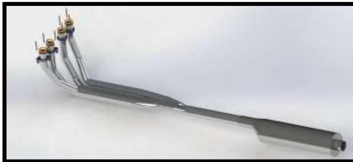
**Figura 2. 6.** Múltiple de escape original del motor Yamaha FZR600
