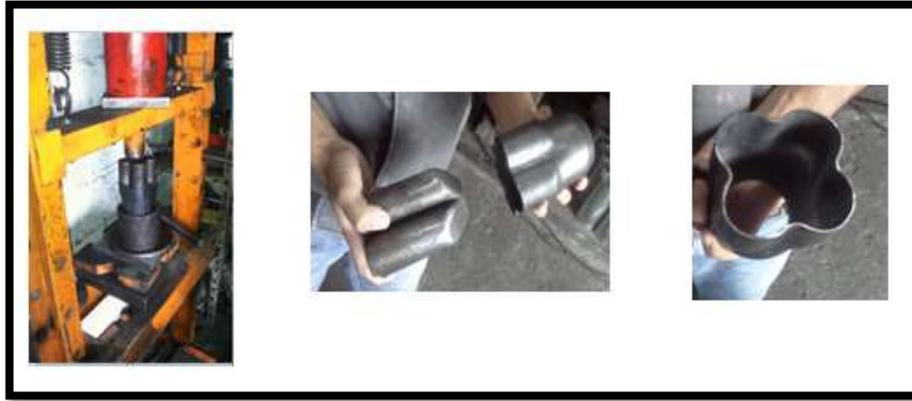
**Figura 3. 17.** Fabricación de la unión 4-1 para el múltiple de escape
