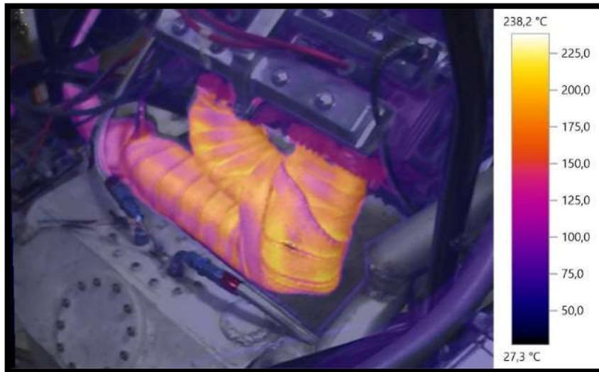
**Figura 4. 9.** Sistema de escape con aislamiento térmico
