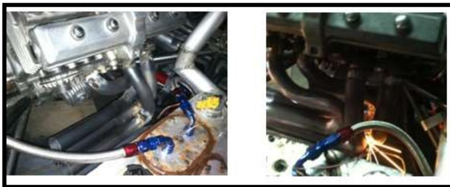
**Figura 3. 16.** Ubicación en el motor y suelda de los tubos del colector primario
