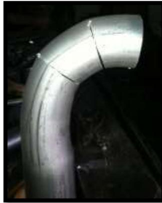
**Figura 3. 14.** Cortes en el tubo para formar radios de curvatura requeridos
