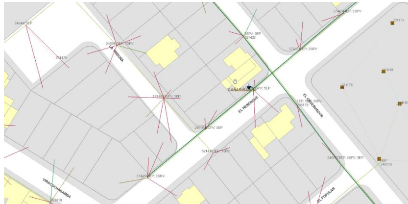
Fig. 2.7, Descripción de la Red de Distribución
