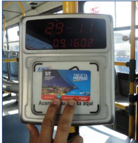
Figura 1-7 Sistema de pago mediante tarjeta. Fuente: Autores.
