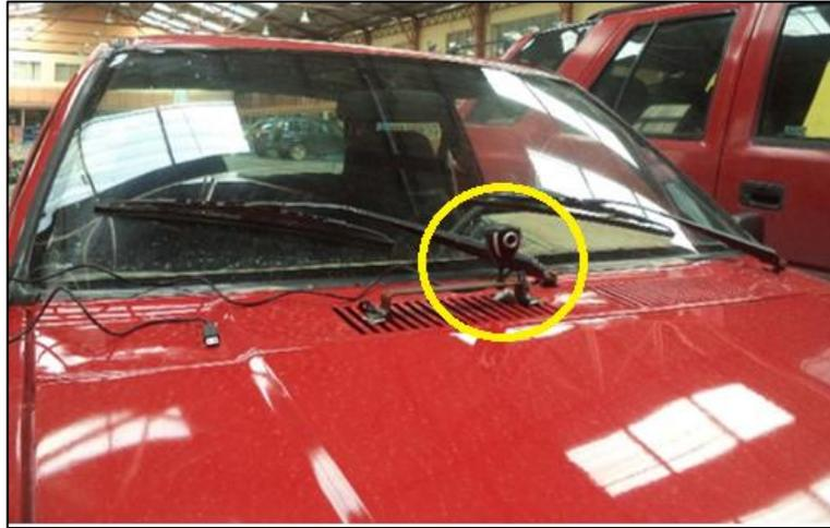
**Figura 3.13:** Posición de la Cámara Web en el Vehículo.
