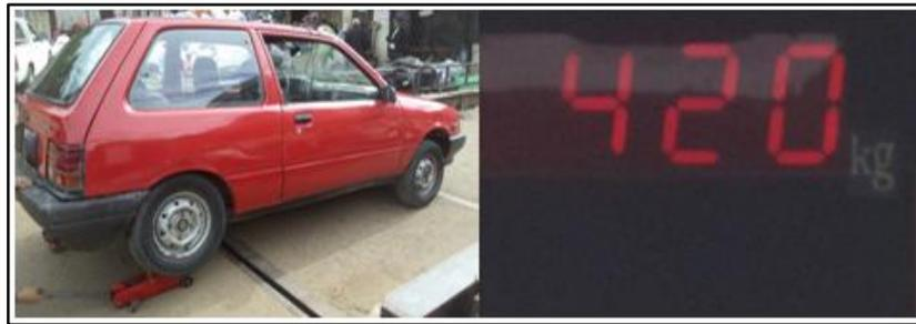
**Figura 2.8:** Peso al Levantar la Parte Posterior del Vehículo.
