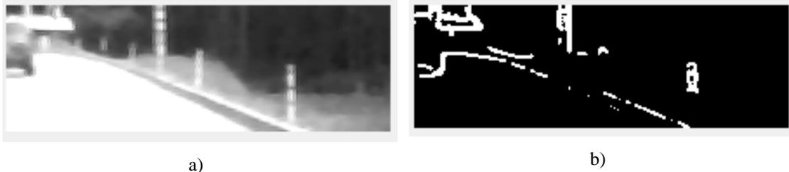
**Figura 3.32:** Parámetros a cambiar en el bloque 2-D FIR Filter en [1 0 1], (a) FIR y (b) Filtrado de la imagen.
