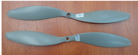
Figura 3.5: Hélices del Arducopter 3DR. (Fuente: Autor)
