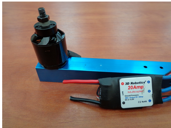
Figura 3.4: Motor Brushless bc2836-9. (Fuente: Autor)
