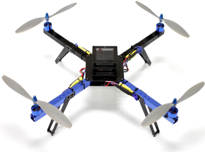
Figura 1.5: 3DR ArduCopter para la implementación experimental de los algoritmos de control.
