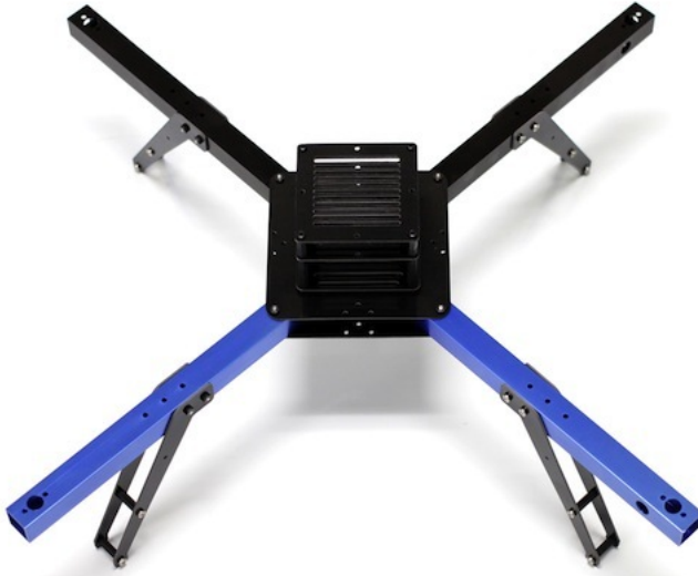
Figura 3.1: Estructura del 3DR ArduCopter Quad-C. (Fuente: www.exp-tech.de )
