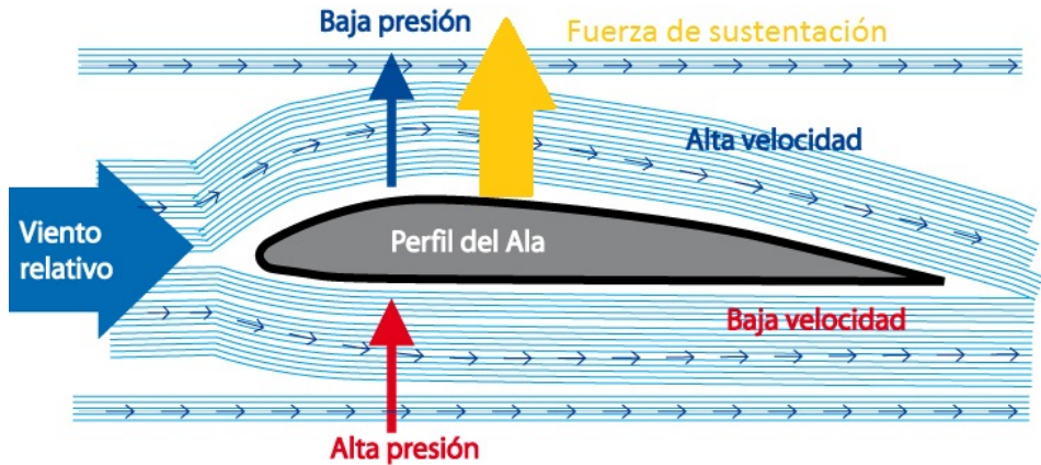
Figura 1.6: Principio de sustentación de Bernoulli. (Fuente: www.pasionporvolar.com )
