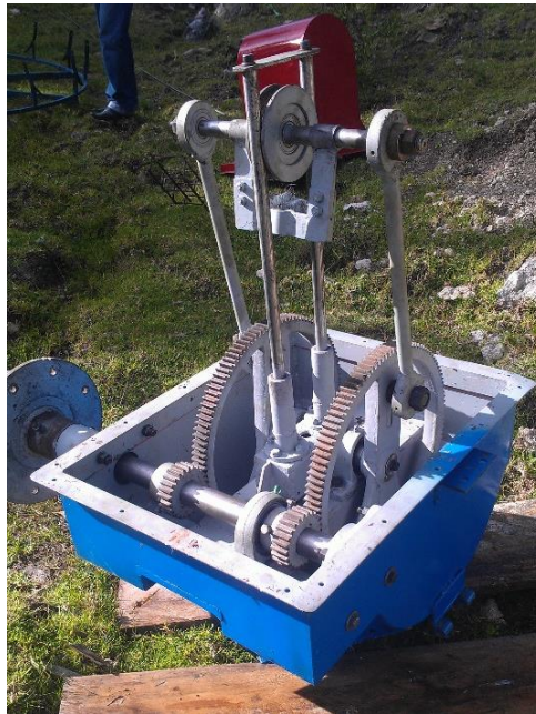
Fig. 3.10 Reductor de velocidad
