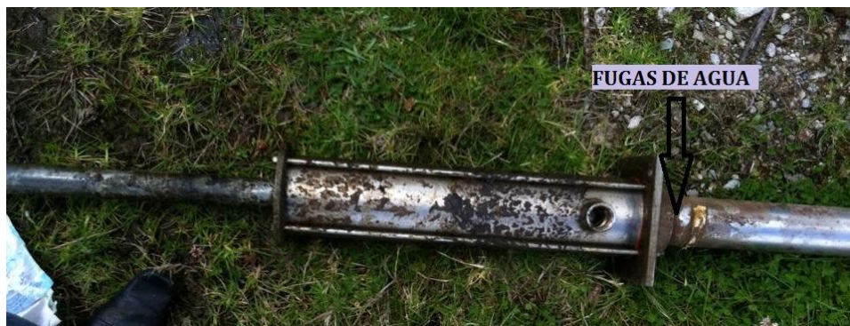
Fig. 3.21. Fugas en la bomba de agua
