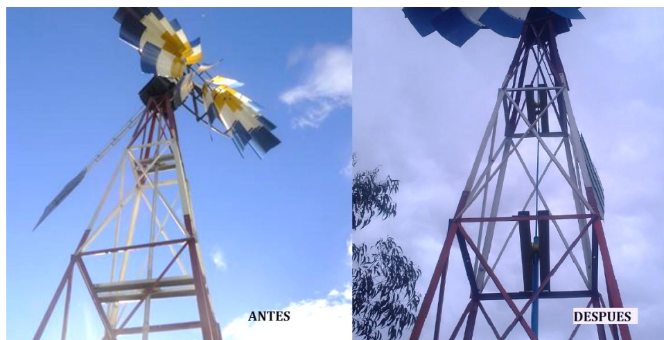
Fig. 3.18 Vástago instalado en Aerobomba
