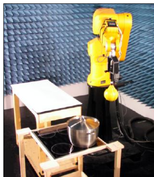
Figura 1.2 Evaluación experimental de niveles de exposición de campo B en cocinas de inducción [7]
