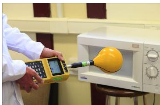
Figura 1.3 Evaluación experimental de niveles de exposición electromagnética de hornos microonda [7]
