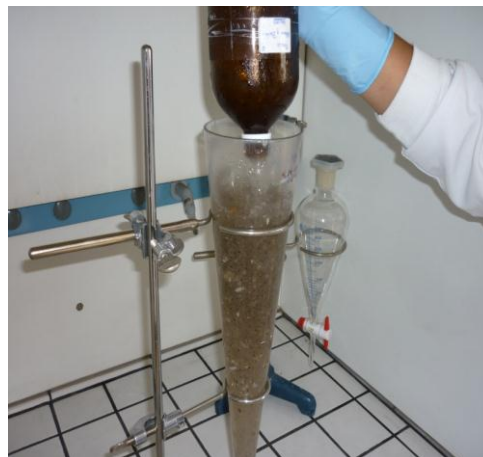
Imagen 8. Determinación de sólidos sedimentables
