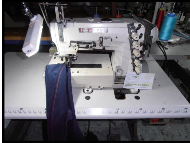
Figura 38. Máquina Recubridora KANSAI SPECIAL WX semipesada (Fuente: Manual de instrucciones de la Recubridora KANSAI SPECIAL WX semipesada).
