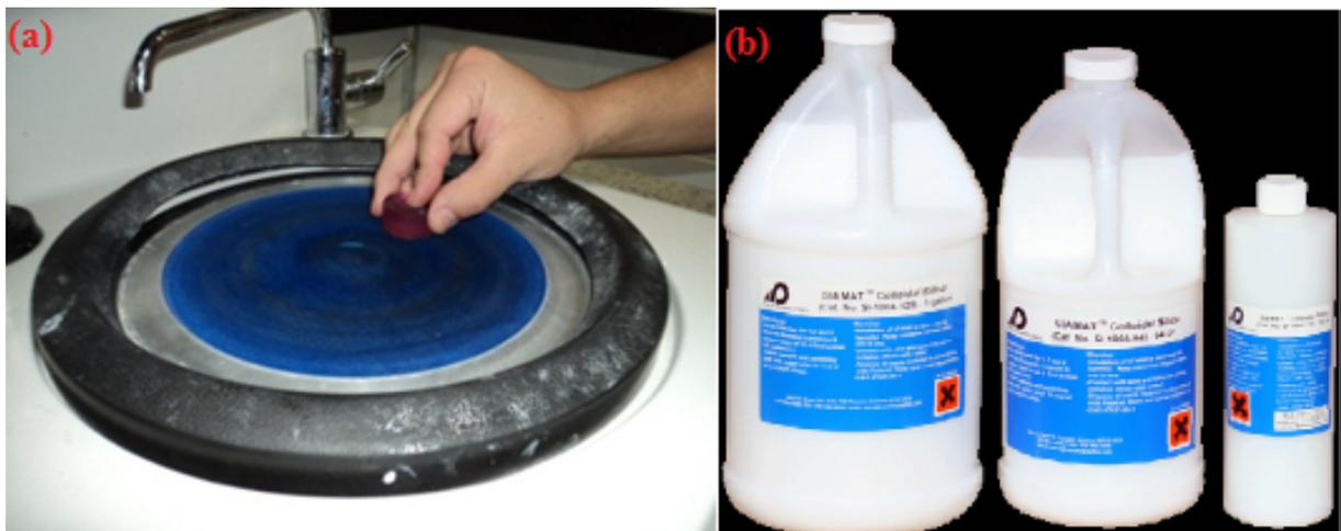
**Figura 2.7:** (a) Pulido manual paño ATLANTIS Fuente: Autores. (b) Alúmina de 0,3  $\mu\text{m}$  High Viscosity [15].
