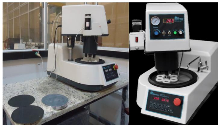
**Figura 2.5:** Pulidora semiautomática PACE TECHNOLOGIC NANO 1000T / FEMTO 1100 Polishing Head [16].
