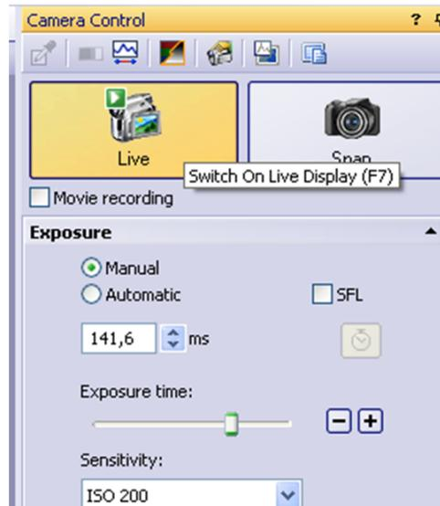
**Figura 3.18:** Ajuste del tiempo de exposición. **Fuente:** Autores
