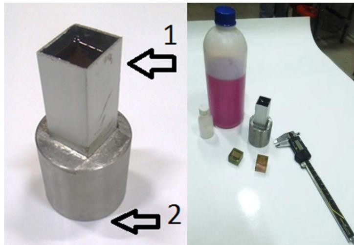
**Figura 2.4:** Embebido de las probetas. **Fuente:** Autores
